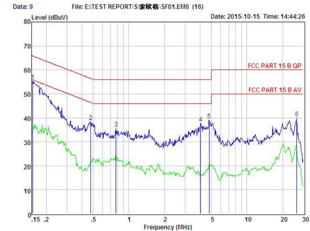
Condition : FCC PART 15 B QP      POL: LINE      Temp: 25.7 °C Hum: 51 %
