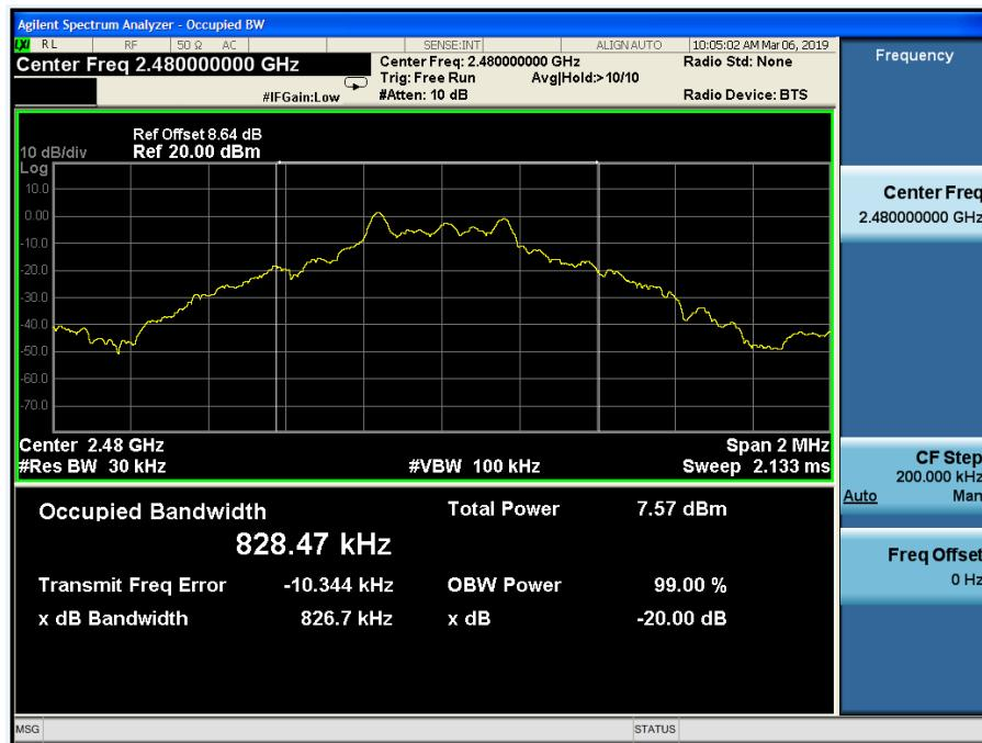
Test Mode:  $\pi/4$ DQPSK
