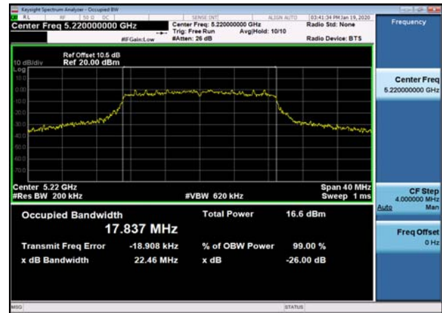
U-NII-1 26dB Bandwidth-802.11ac(40MHz) ,5190MHz
