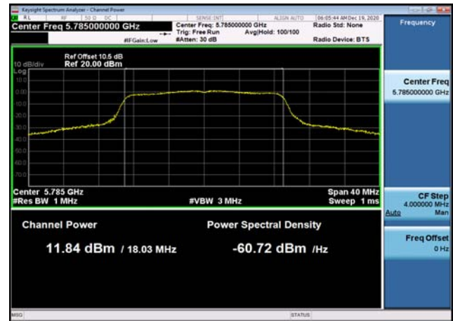
U-NII-3 Output Power-802.11n(40MHz) ,5755MHz
