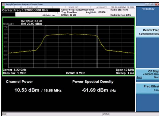
U-NII-1 Output Power-802.11ac(20MHz) ,5180MHz
