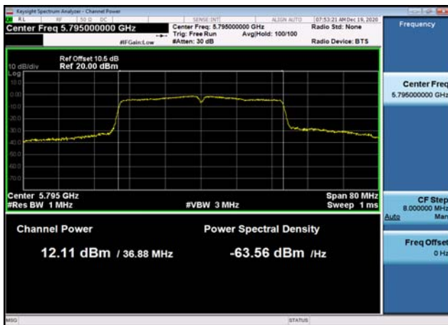
U-NII-3 Output Power-802.11ac(40MHz) ,5795MHz
