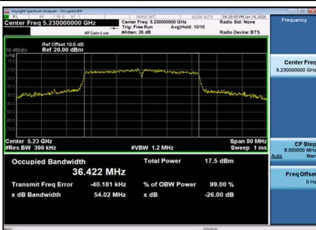
U-NII-1 26dB Bandwidth-802.11n(40MHz) ,5230MHz
