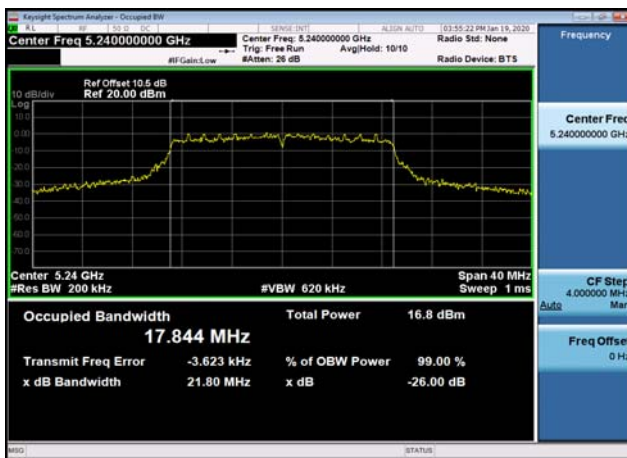
U-NII-1 26dB Bandwidth-802.11ac(20MHz) ,5240MHz
