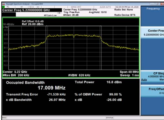
U-NII-1 26dB Bandwidth-802.11ac(20MHz) ,5180MHz
