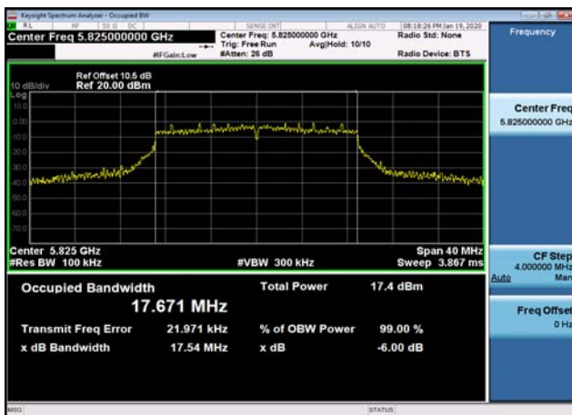
U-NII-3 6dB Bandwidth-802.11ac(40MHz) ,5795MHz
