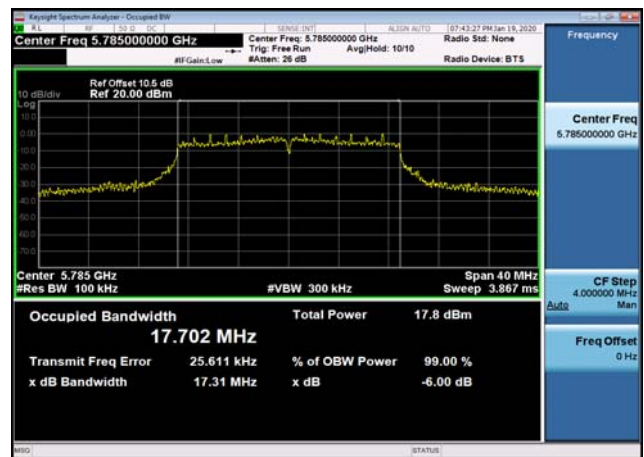
U-NII-3 6dB Bandwidth-802.11n(40MHz) ,5755MHz
