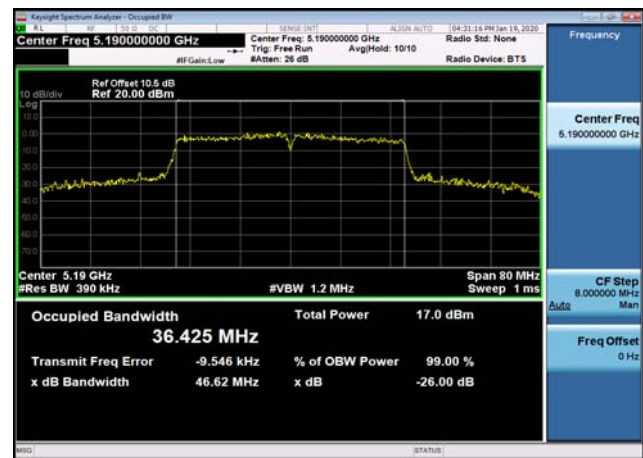
U-NII-1 26dB Bandwidth-802.11ac(40MHz) ,5190MHz
