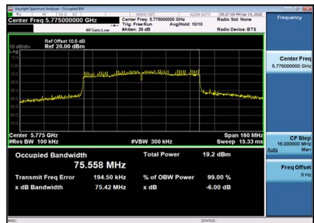
U-NII-3 6dB Bandwidth-802.11ac(80MHz) ,5775MHz
