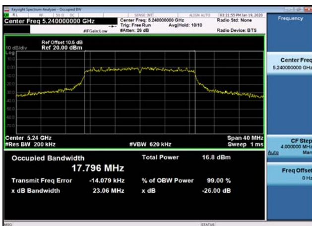
U-NII-1 26dB Bandwidth-802.11n(40MHz) ,5230MHz
