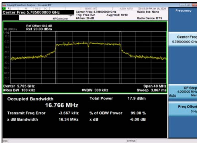
U-NII-3 6dB Bandwidth-802.11ac(20MHz) ,5745MHz
