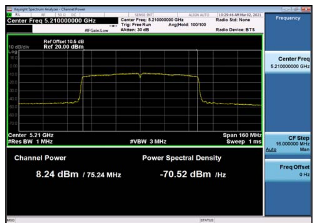
U-NII-1 Output Power-802.11ac(80MHz) ,5210MHz
