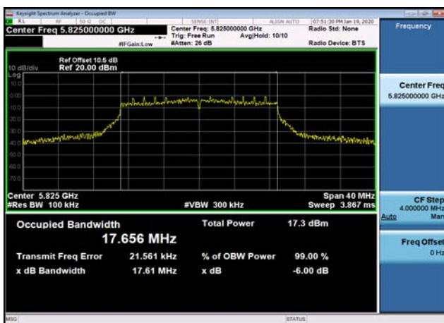
U-NII-3 6dB Bandwidth-802.11n(20MHz) ,5825MHz
