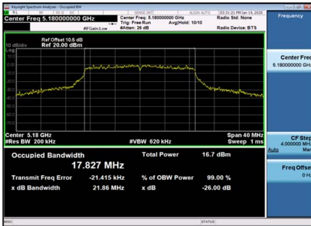
U-NII-1 26dB Bandwidth-802.11ac(20MHz) ,5240MHz
