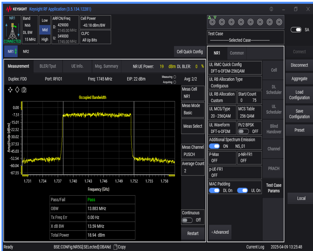
n66 SCS=15kHz DFT_QAM256 BW=10MHz Channel=349000 RB=50@0
