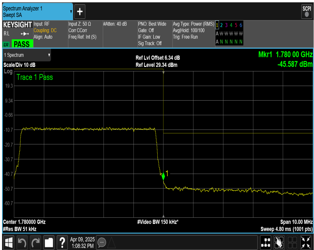
n66 SCS=15kHz CP_QPSK BW=5MHz Channel=355500 RB=1@24
