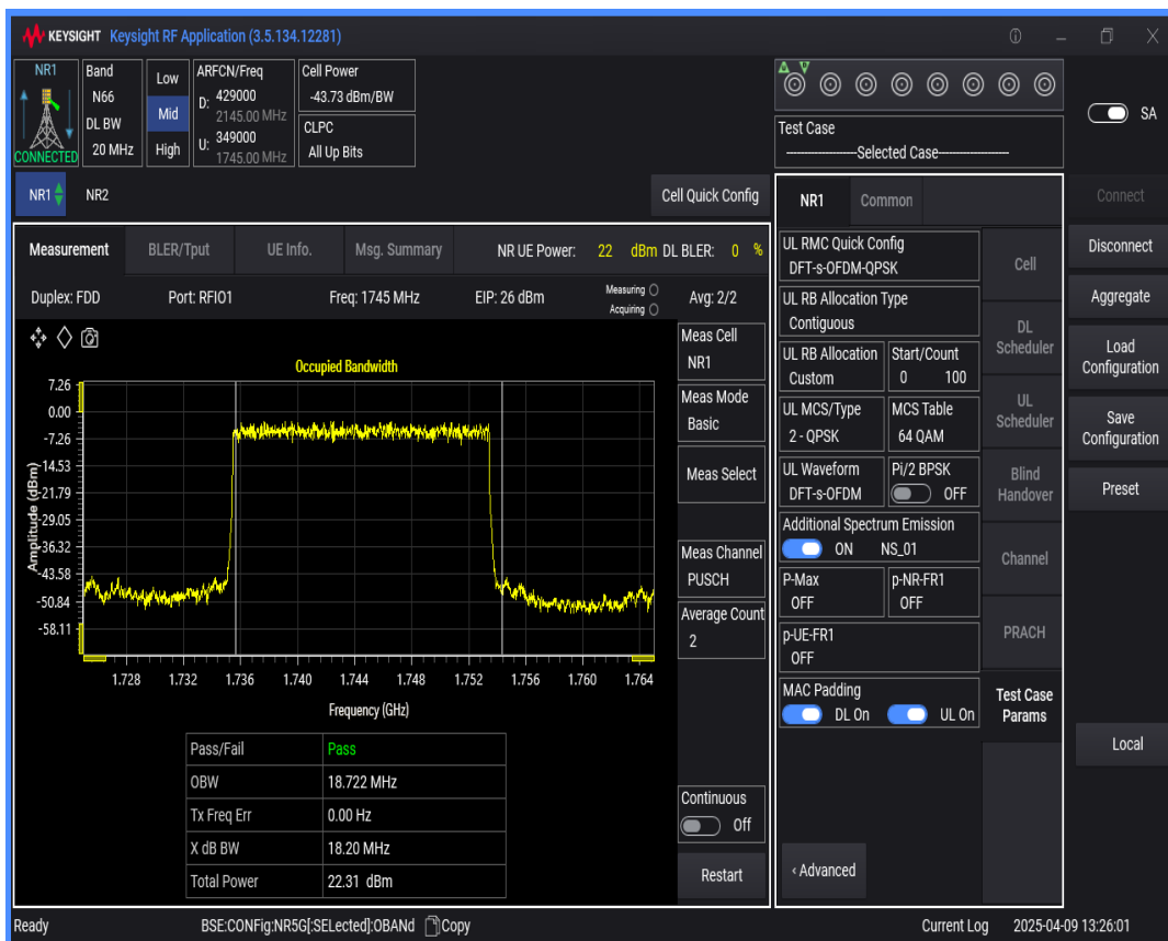
n66 SCS=15kHz DFT_QPSK BW=5MHz Channel=349000 RB=25@0
