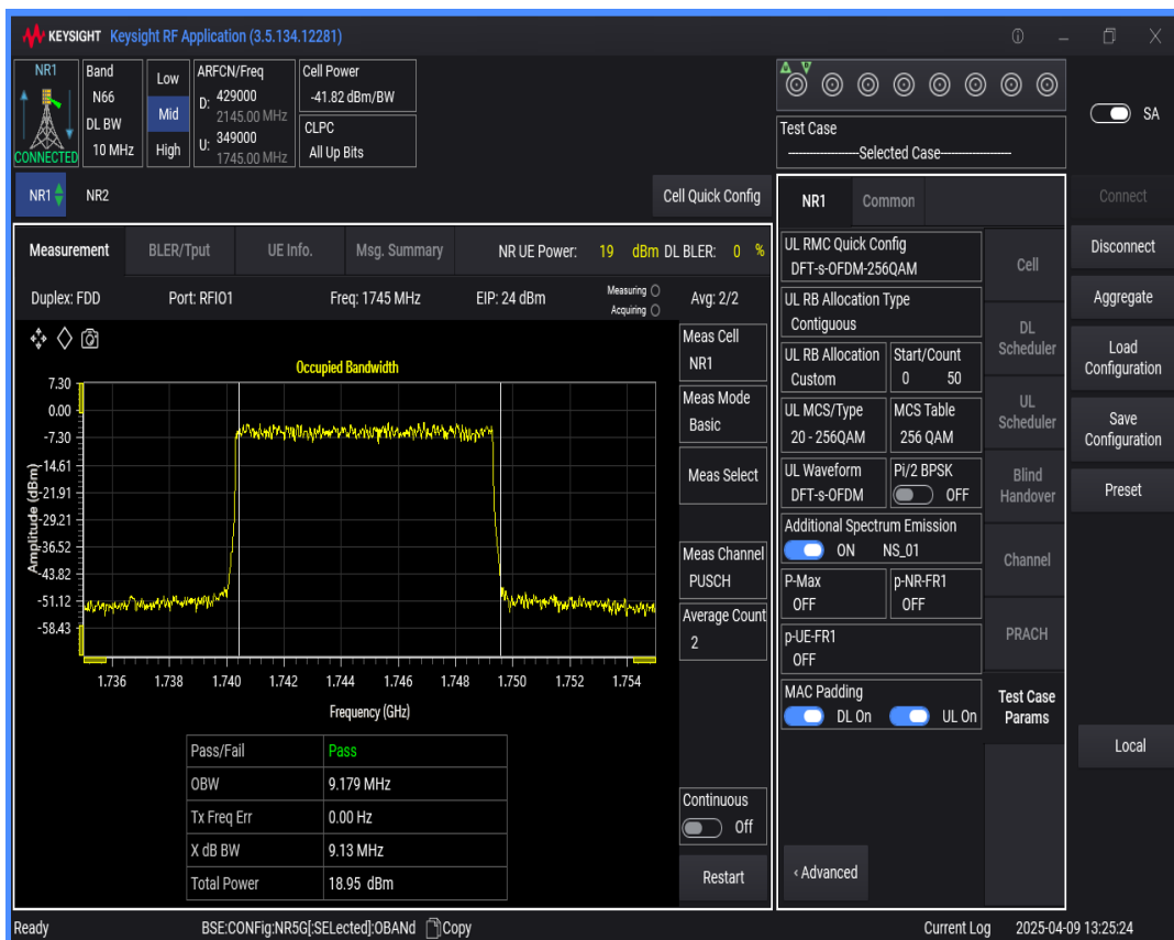
n66 SCS=15kHz DFT_QAM256 BW=20MHz Channel=349000 RB=100@0
