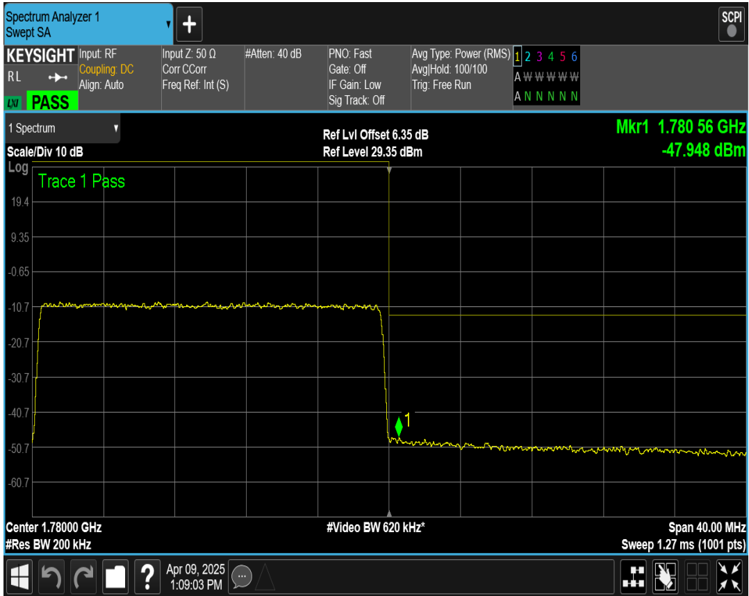
n66 SCS=15kHz CP_QPSK BW=40MHz Channel=352000 RB=1 @215
