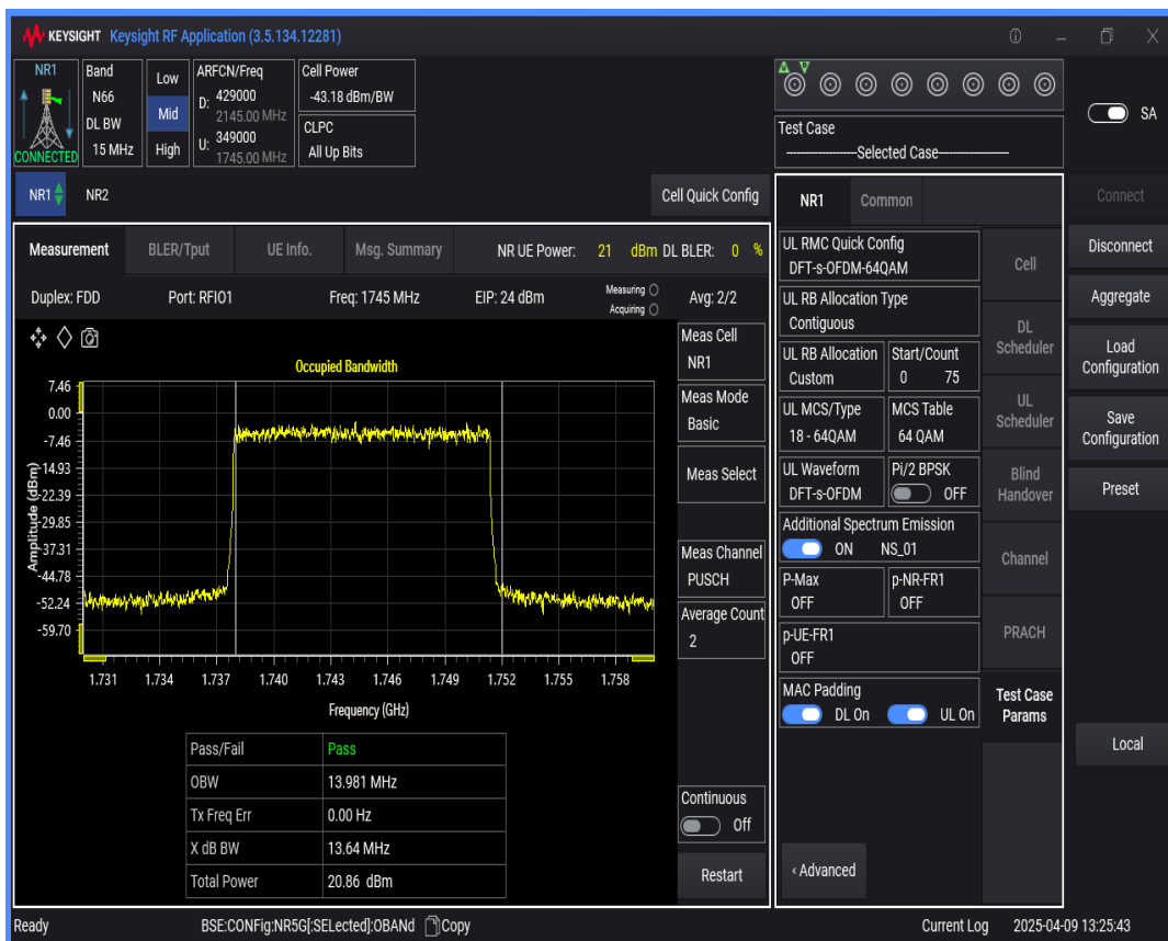
n66 SCS=15kHz DFT_QAM64 BW=10MHz Channel=349000 RB=50@0
