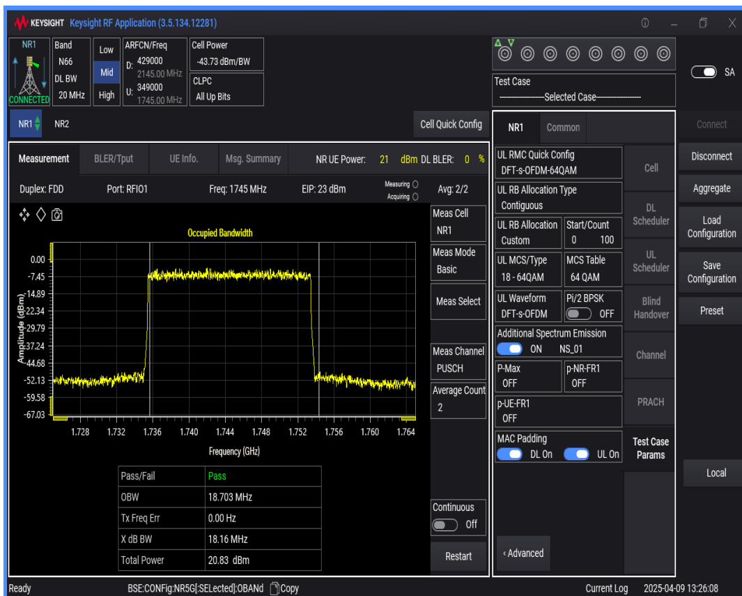
n66 SCS=15kHz DFT_QPSK BW=10MHz Channel=349000 RB=50@0
