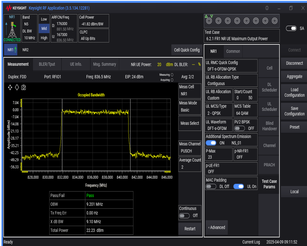
n5 SCS=15kHz DFT_QPSK BW=20MHz Channel=167300 RB=100@0
