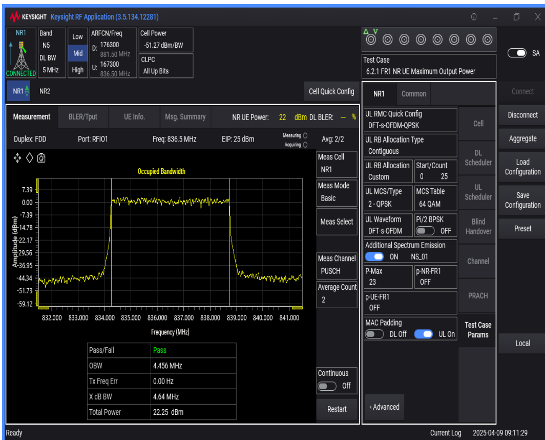
n5 SCS=15kHz DFT_QPSK BW=5MHz Channel=167300 RB=25@0
