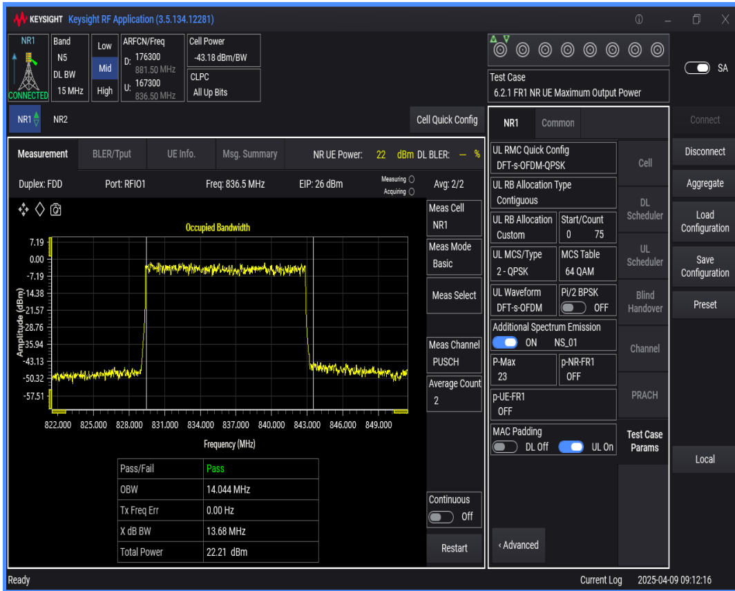
n5 SCS=15kHz DFT_QPSK BW=5MHz Channel=167300 RB=25@0
