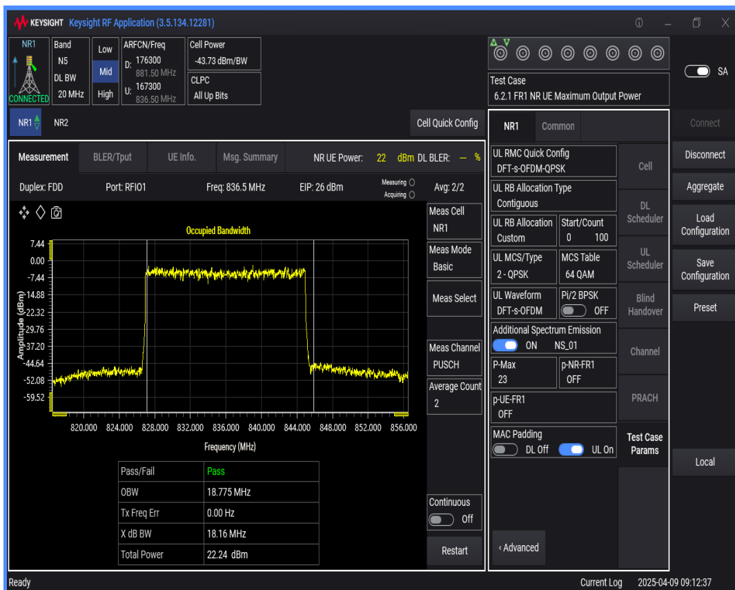
n5 SCS=15kHz DFT_QPSK BW=15MHz Channel=167300 RB=75@0
