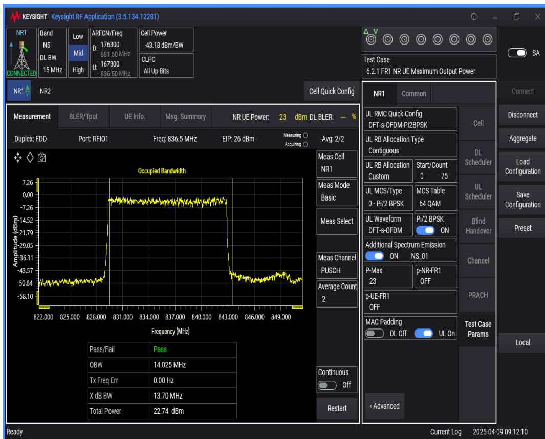
n5 SCS=15kHz DFT_BPSK BW=20MHz Channel=167300 RB=100 @0
