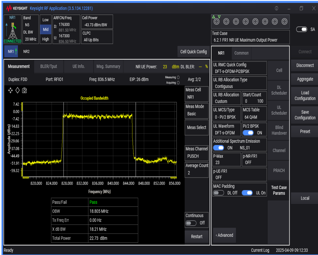
n5 SCS=15kHz DFT_QAM16 BW=10MHz Channel=167300 RB=50@0
