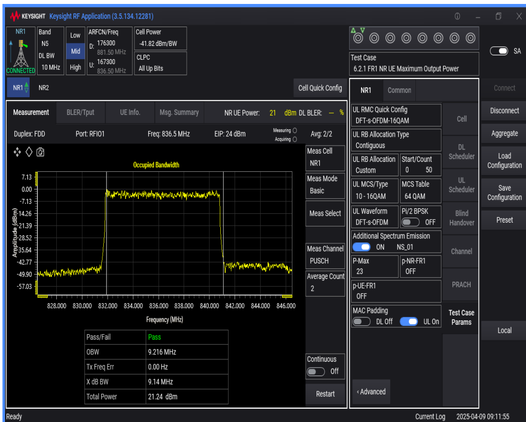
n5 SCS=15kHz DFT_BPSK BW=5MHz Channel=167300 RB=25@0
