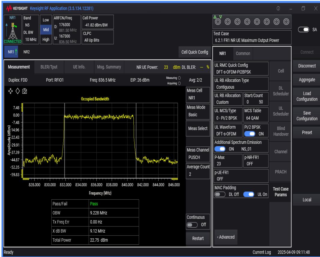
n5 SCS=15kHz DFT_BPSK BW=15MHz Channel=167300 RB=75 @0
