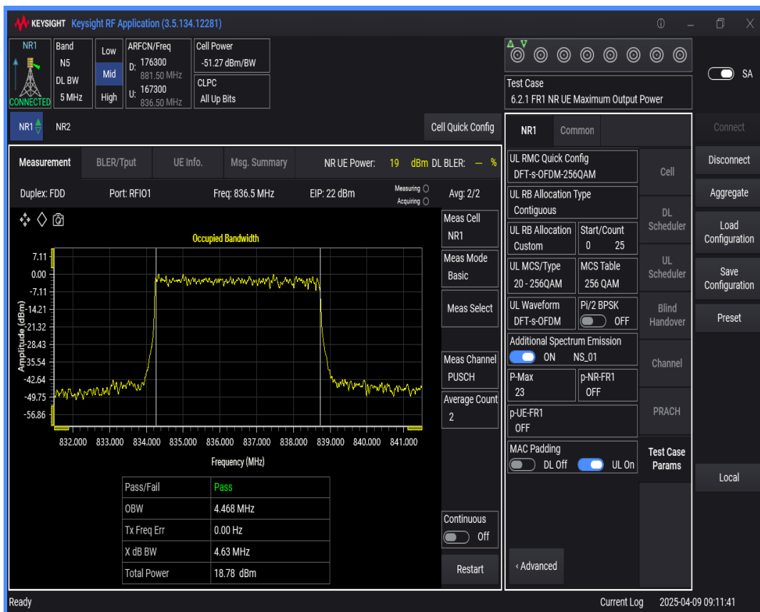
n5 SCS=15kHz DFT_QAM256 BW=20MHz Channel=167300 RB=100@0
