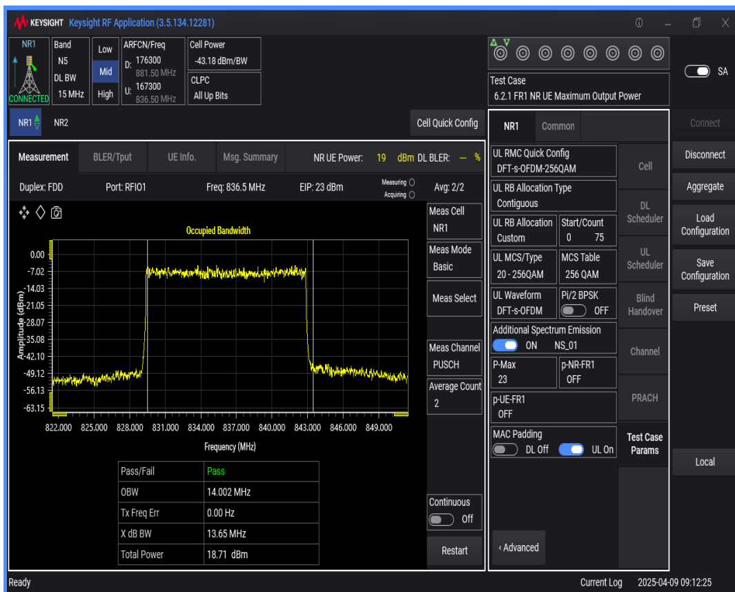
n5 SCS=15kHz DFT_QAM64 BW=10MHz Channel=167300 RB=50@0
