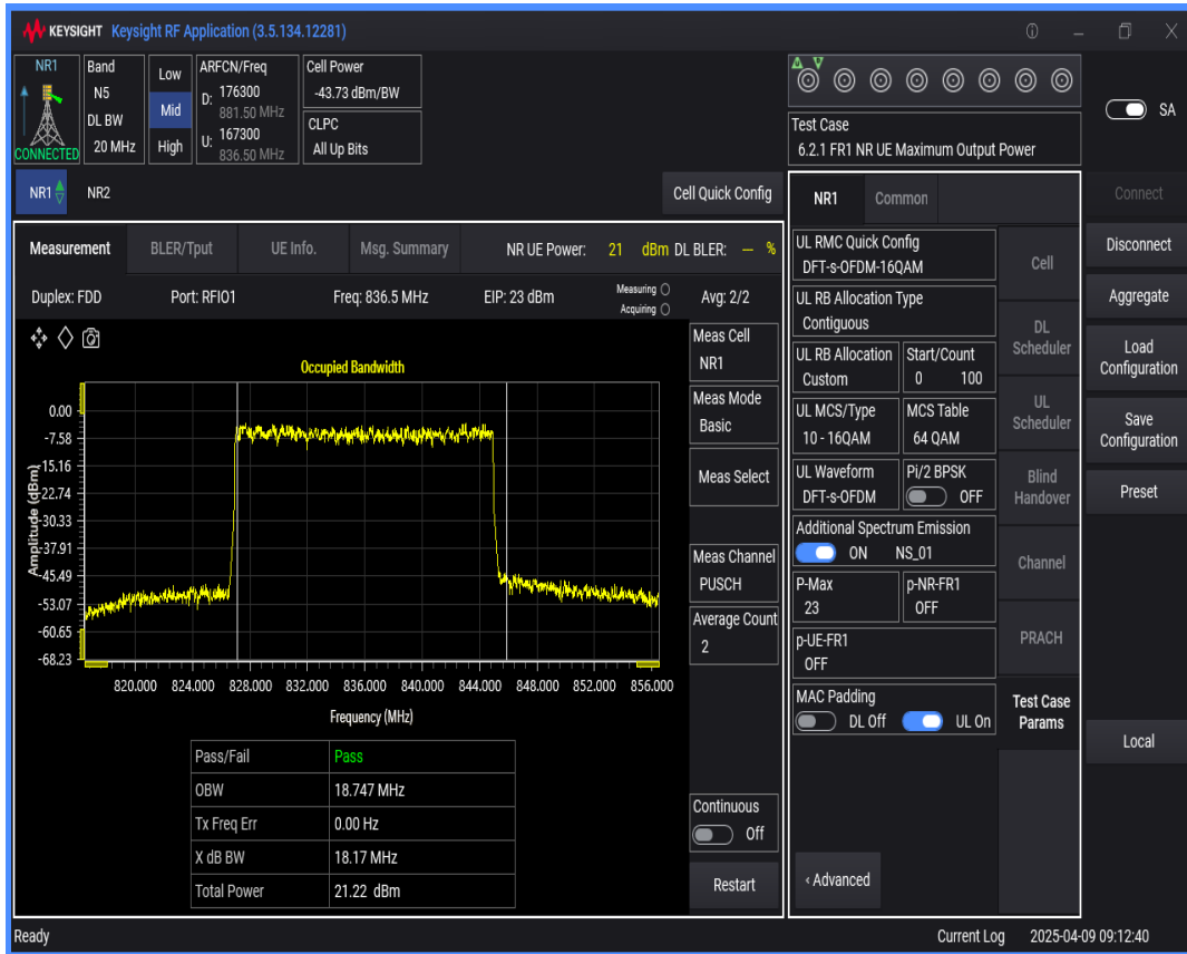
n5 SCS=15kHz DFT_QAM256 BW=10MHz Channel=167300 RB=50@0
