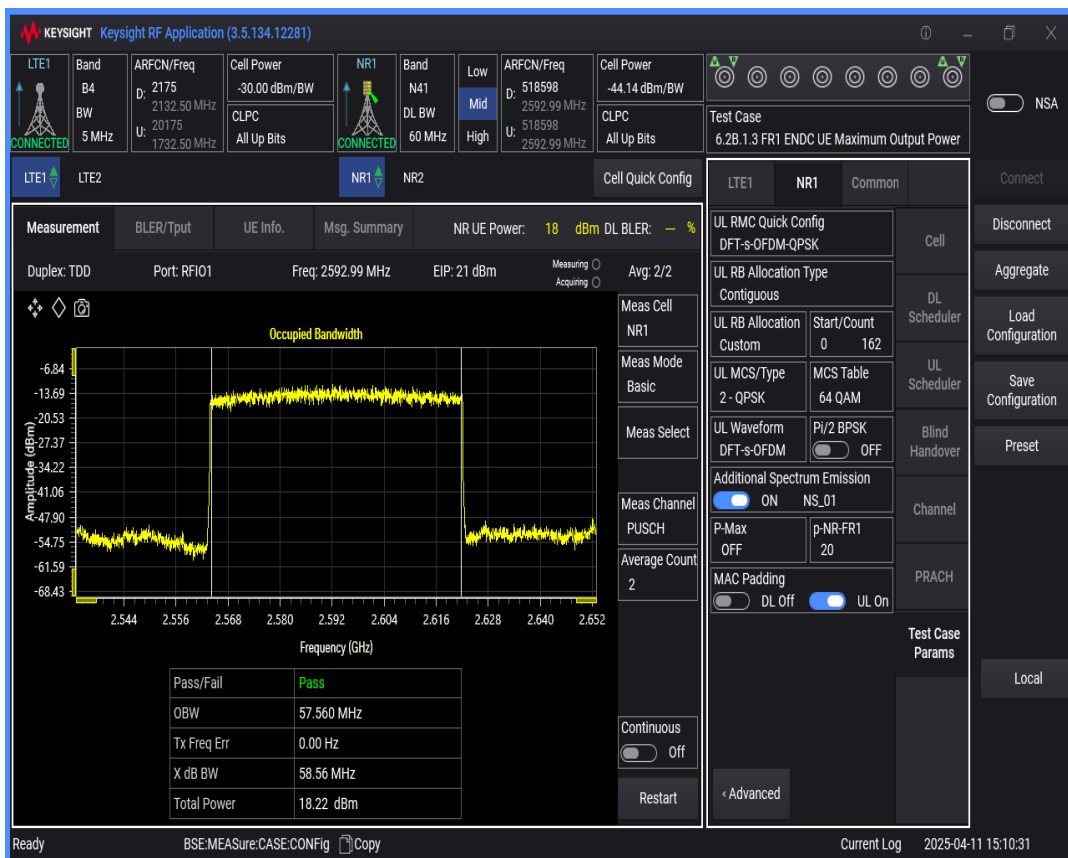
n41 SCS=30kHz DFT_QPSK BW=90MHz Channel=518598 RB=240@0
