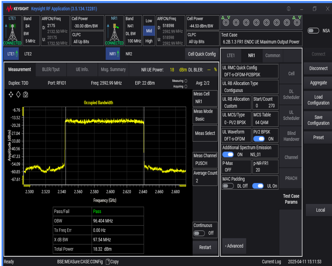
n41 SCS=30kHz DFT_BPSK BW=20MHz Channel=518598 RB=50@0
