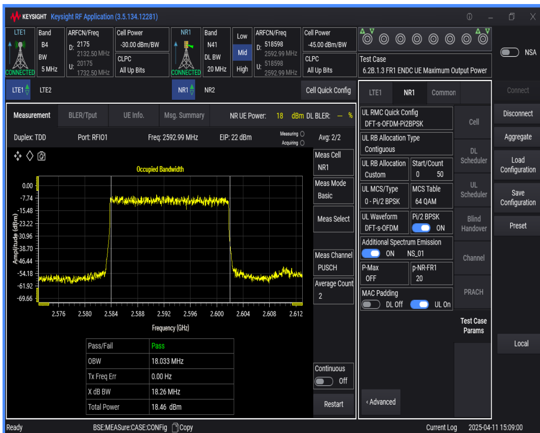
n41 SCS=30kHz DFT_BPSK BW=40MHz Channel=518598 RB=100@0
