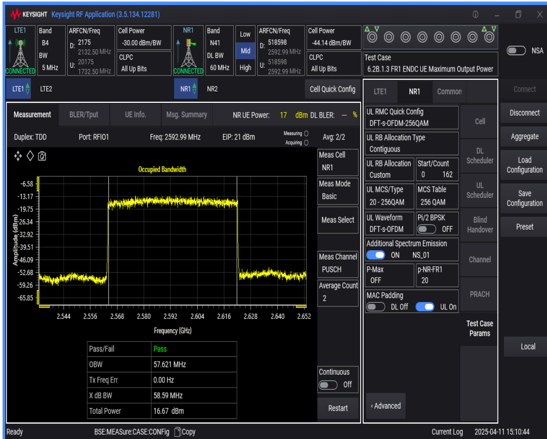
n41 SCS=30kHz DFT_QPSK BW=50MHz Channel=518598 RB=128@0
