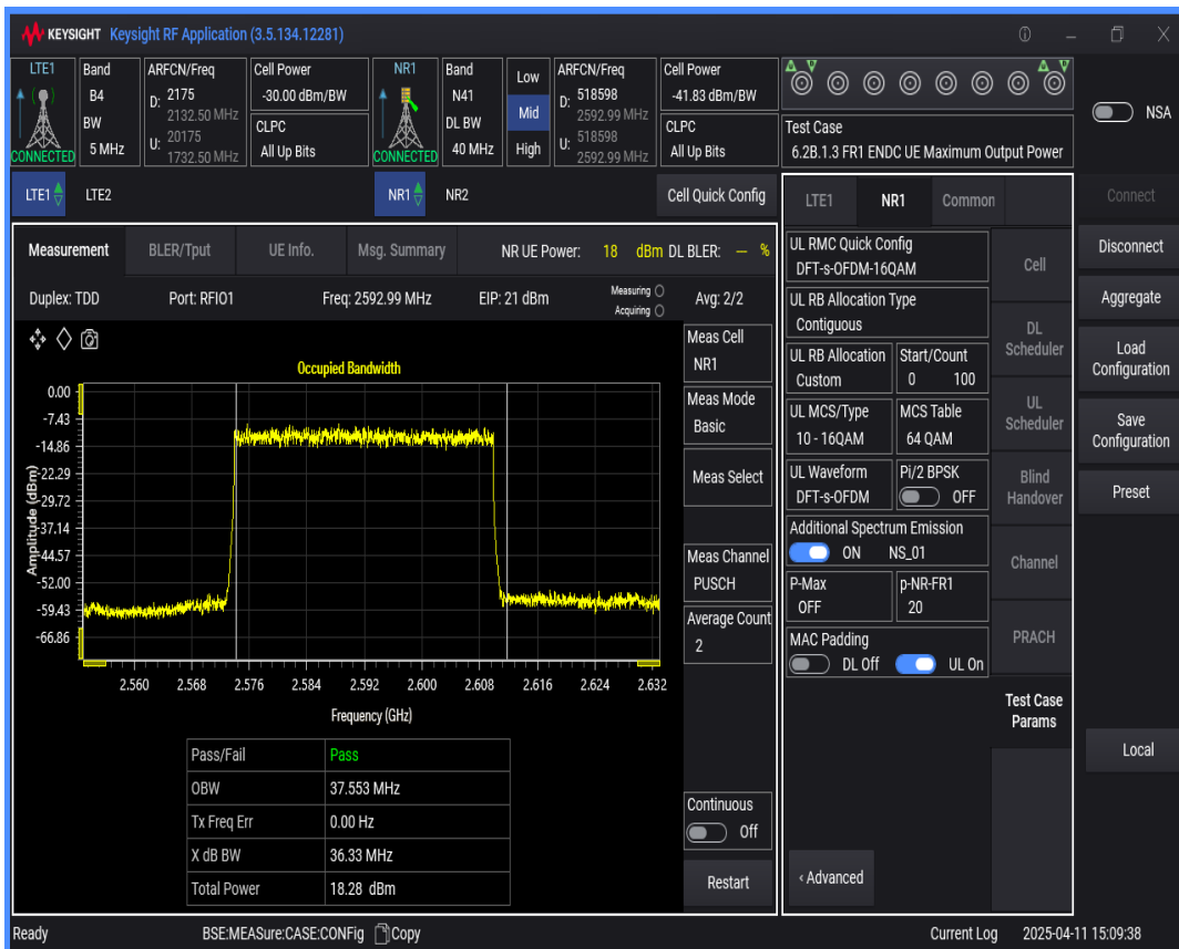
n41 SCS=30kHz DFT_QAM64 BW=20MHz Channel=518598 RB=50@0
