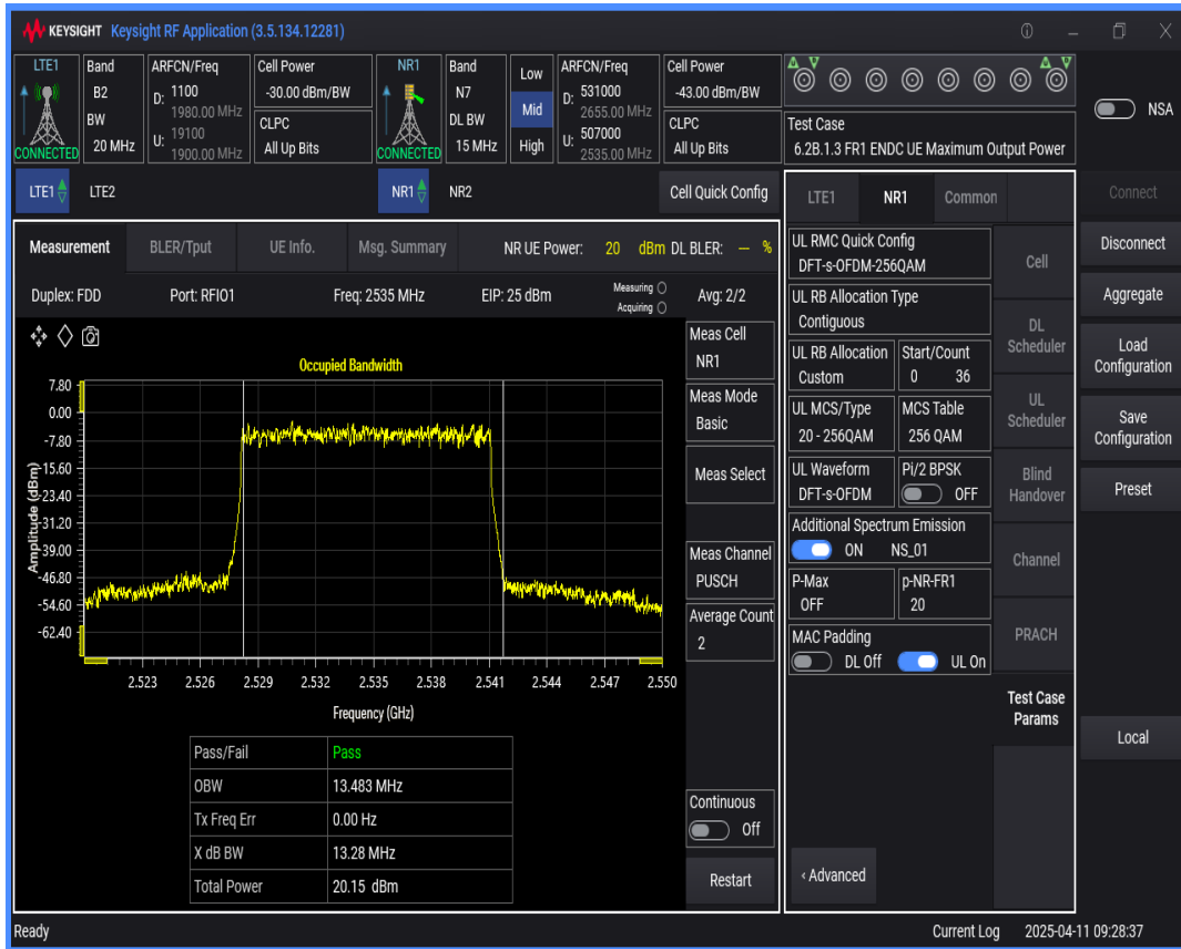
n7 SCS=30kHz DFT_BPSK BW=20MHz Channel=507000 RB=50 @0
