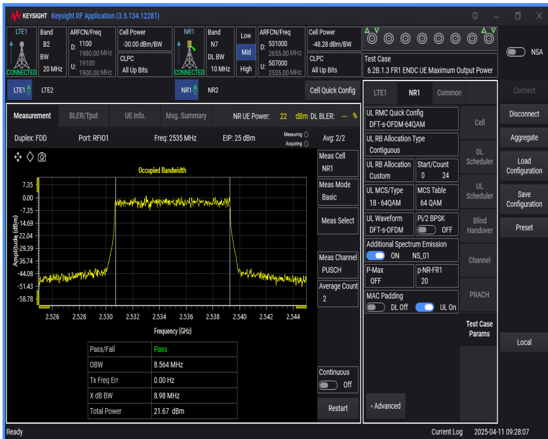
n7 SCS=30kHz DFT_QAM256 BW=20MHz Channel=507000 RB=50@0
