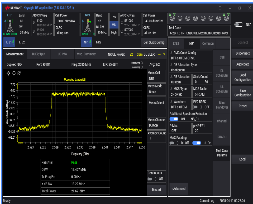
n7 SCS=30kHz DFT_QPSK BW=20MHz Channel=507000 RB=50 @0
