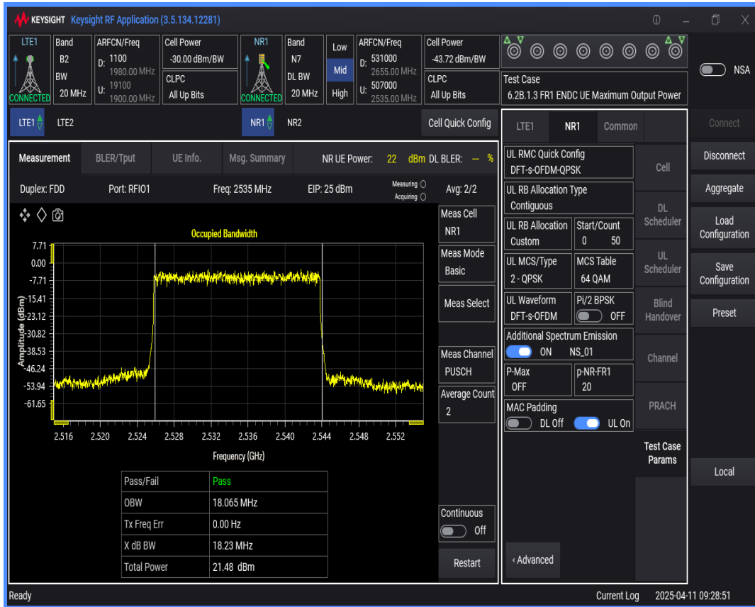
n7 SCS=30kHz DFT_QAM64 BW=20MHz Channel=507000 RB=50@0
