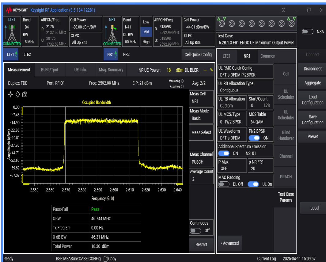
n41 SCS=30kHz DFT_BPSK BW=40MHz Channel=518598 RB=100@0
