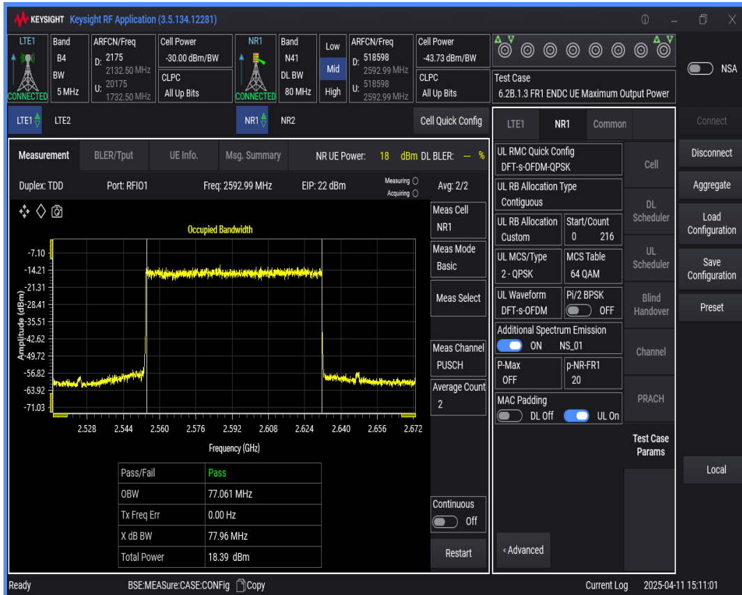
n41 SCS=30kHz DFT_QPSK BW=90MHz Channel=518598 RB=240@0
