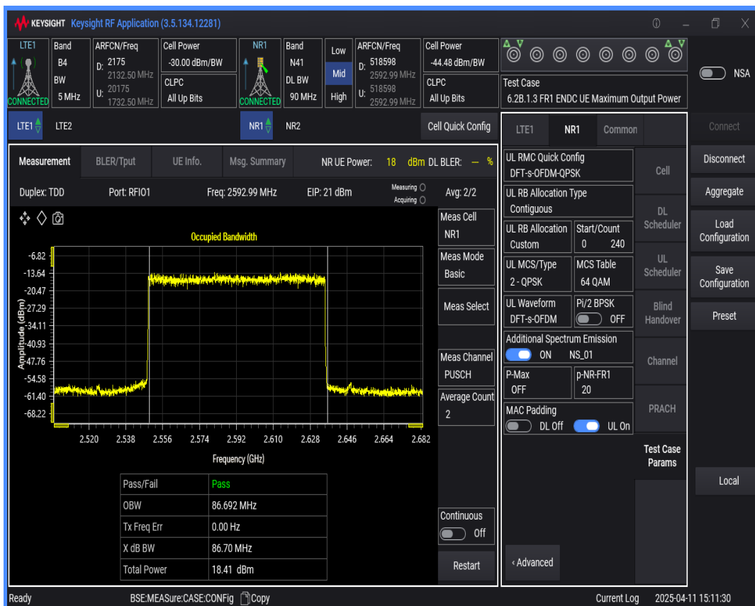
n41 SCS=30kHz DFT_QPSK BW=20MHz Channel=518598 RB=50@0
