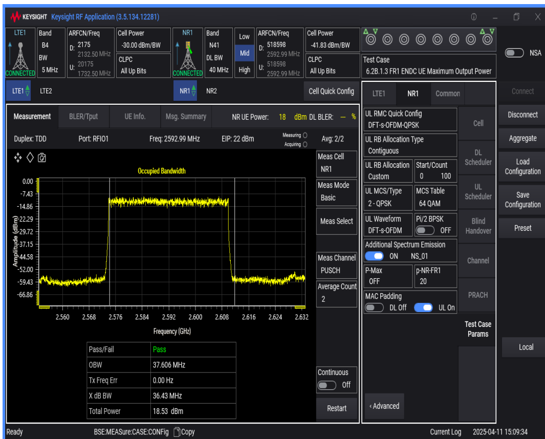
n41 SCS=30kHz DFT_QPSK BW=50MHz Channel=518598 RB=128@0
