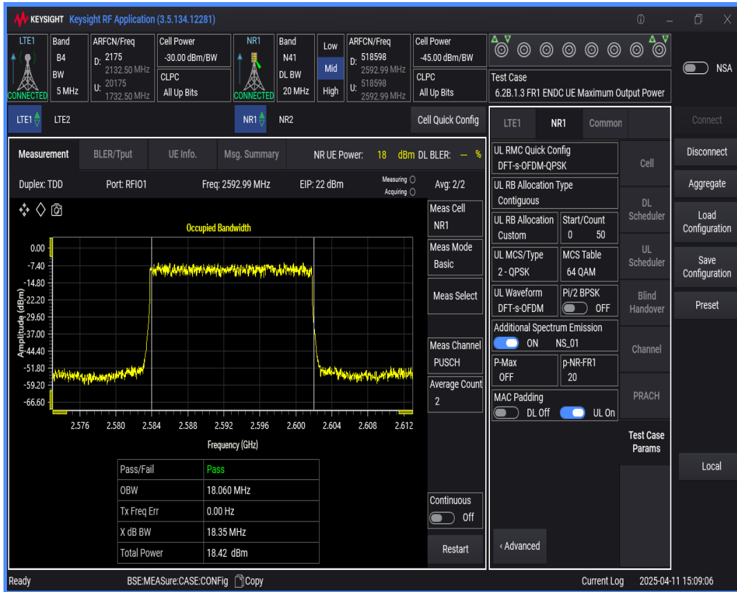
n41 SCS=30kHz DFT_QPSK BW=40MHz Channel=518598 RB=100@0
