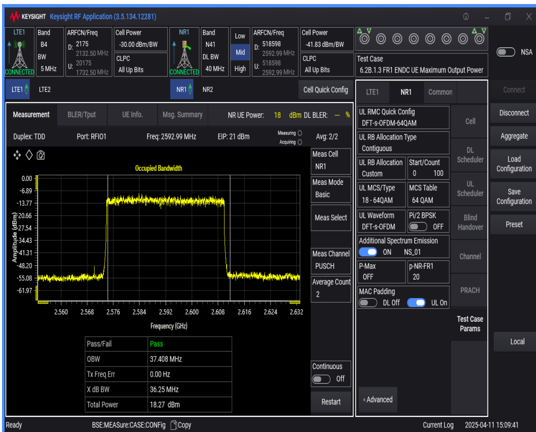
n41 SCS=30kHz DFT_QAM64 BW=20MHz Channel=518598 RB=50@0
