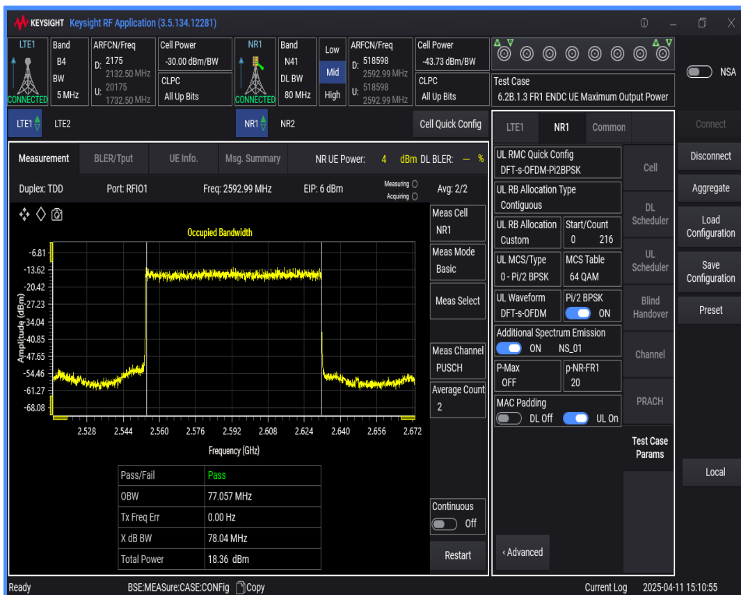
n41 SCS=30kHz DFT_QAM16 BW=20MHz Channel=518598 RB=50@0
