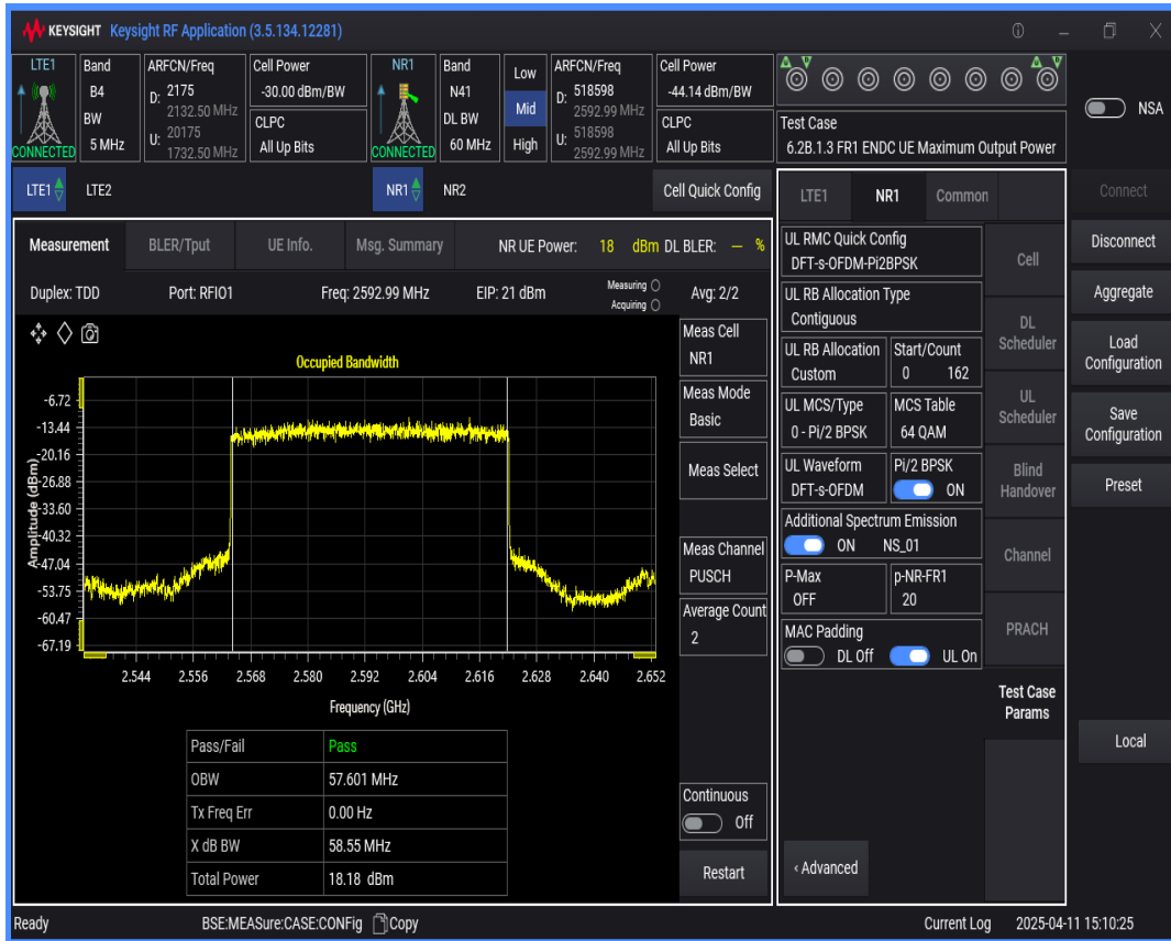
n41 SCS=30kHz DFT_BPSK BW=20MHz Channel=518598 RB=50@0
