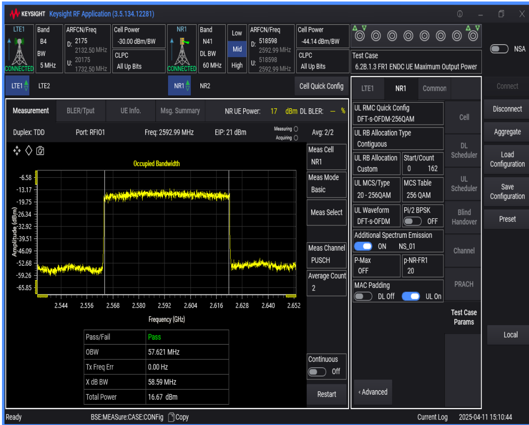
n41 SCS=30kHz DFT_QAM256 BW=20MHz Channel=518598 RB=50@0
