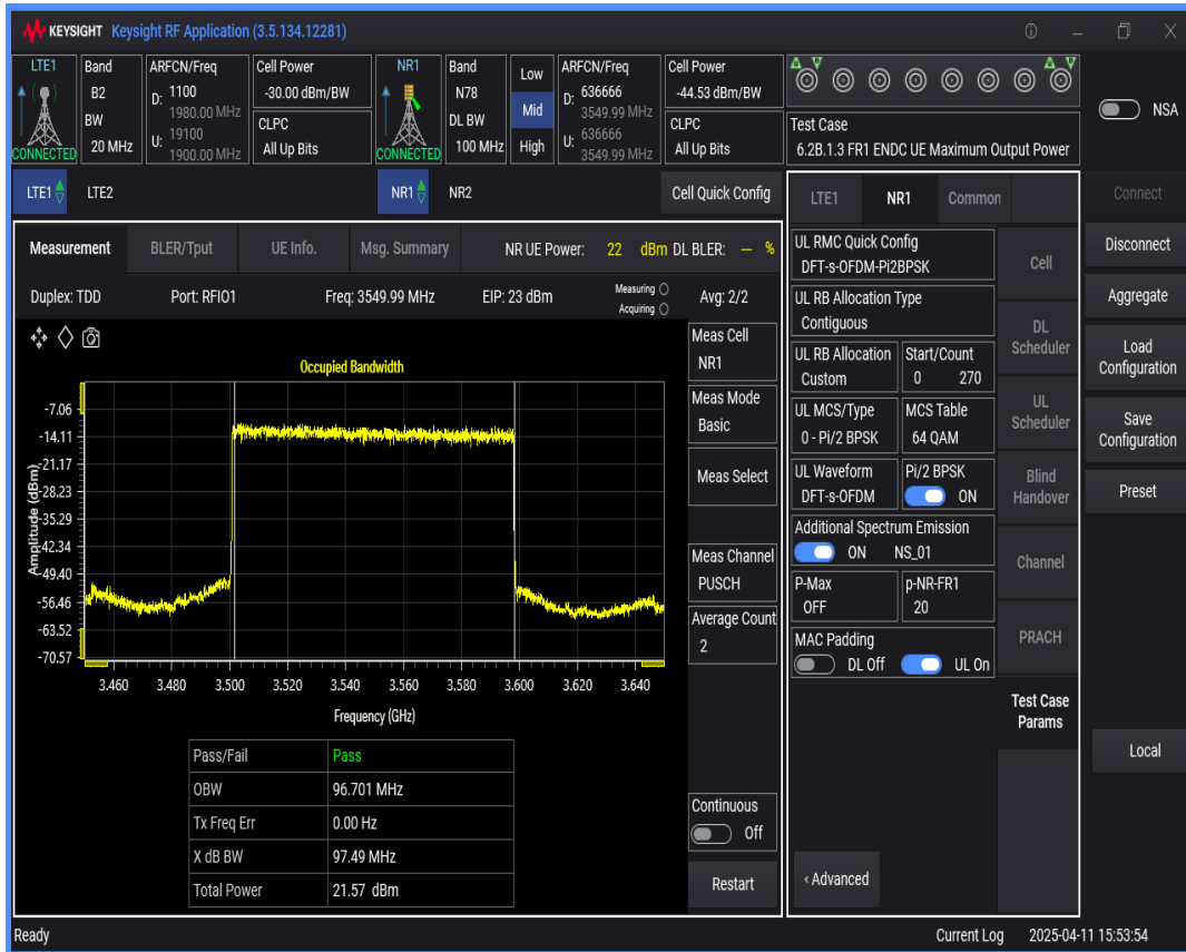
n78 SCS=30kHz DFT_BPSK BW=20MHz Channel=636666 RB=50@0
