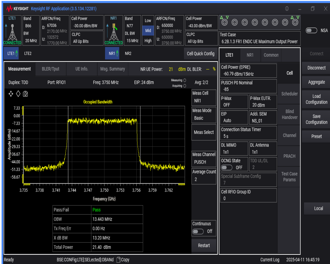
n77 SCS=30kHz DFT_QPSK BW=20MHz Channel=650000 RB=50@0
