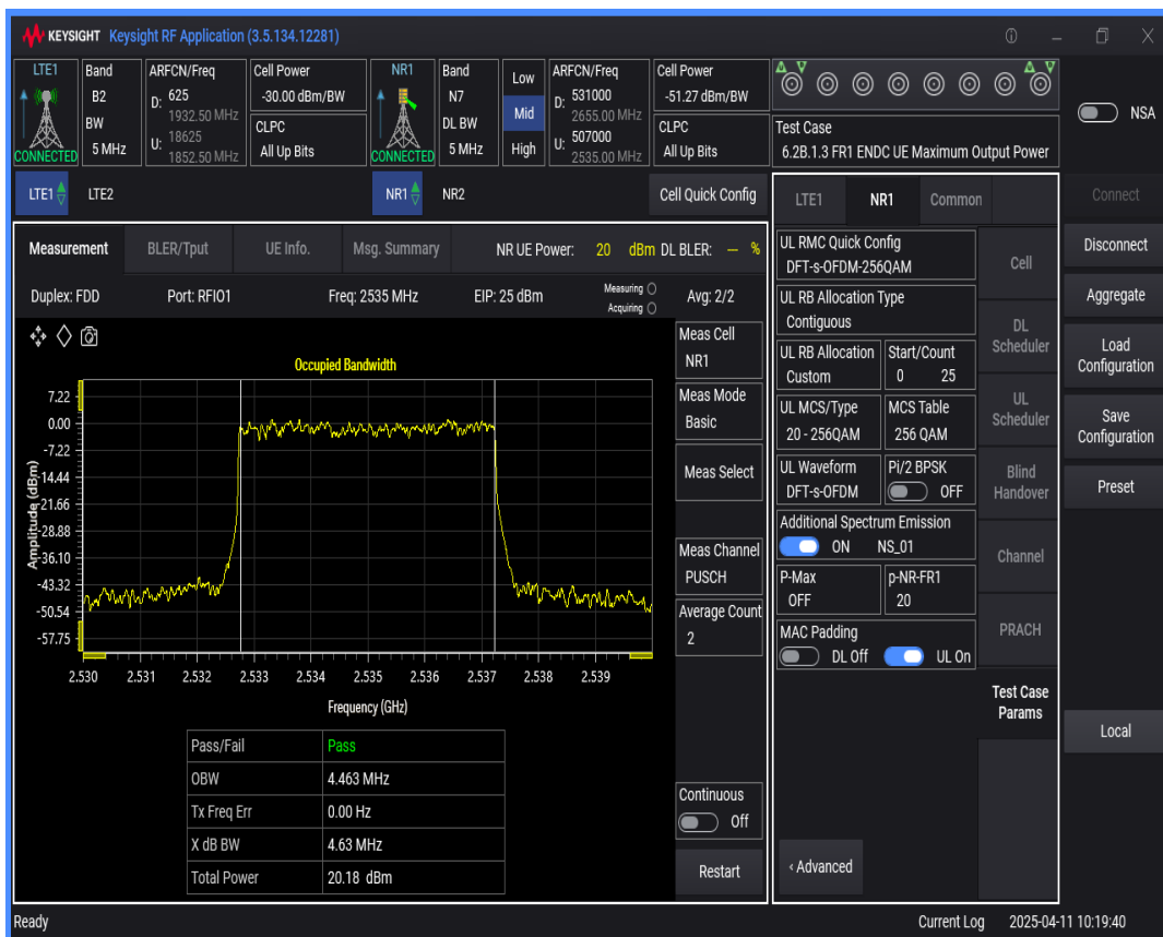
n7 SCS=15kHz DFT_QAM256 BW=10MHz Channel=507000 RB=50@0
