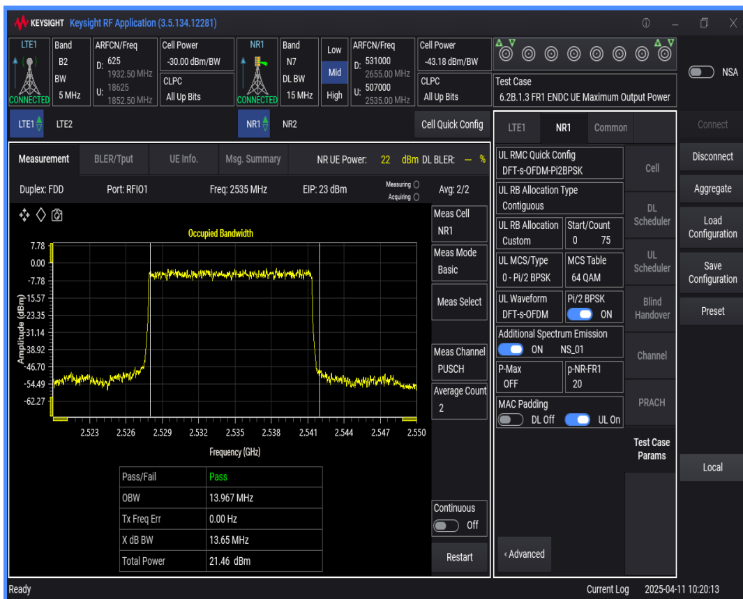
n7 SCS=15kHz DFT_BPSK BW=20MHz Channel=507000 RB=100 @0
