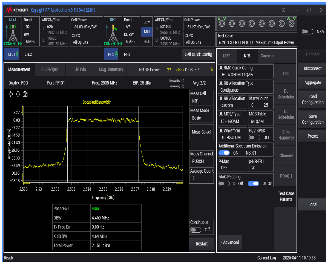
n7 SCS=15kHz DFT_QAM256 BW=20MHz Channel=507000 RB=100 @0
