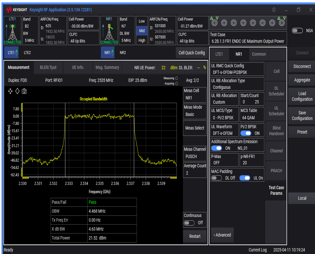
n7 SCS=15kHz DFT_BPSK BW=10MHz Channel=507000 RB=50 @0
