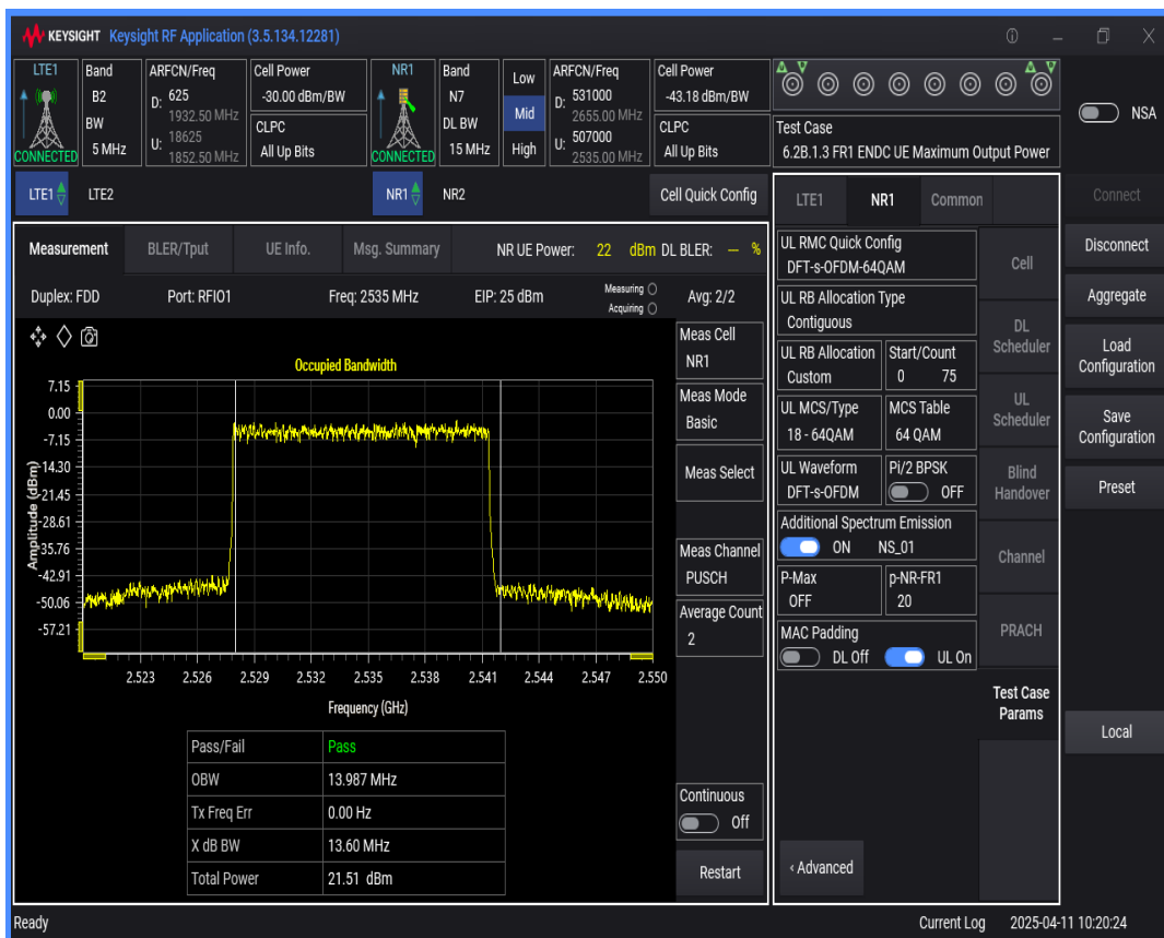
n7 SCS=15kHz DFT_QAM64 BW=10MHz Channel=507000 RB=50@0
