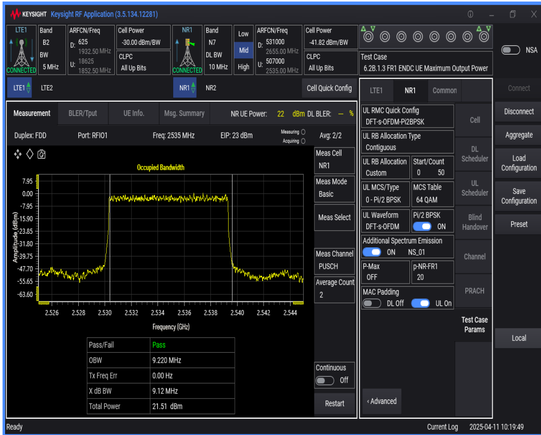
n7 SCS=15kHz DFT_BPSK BW=15MHz Channel=507000 RB=75 @0
