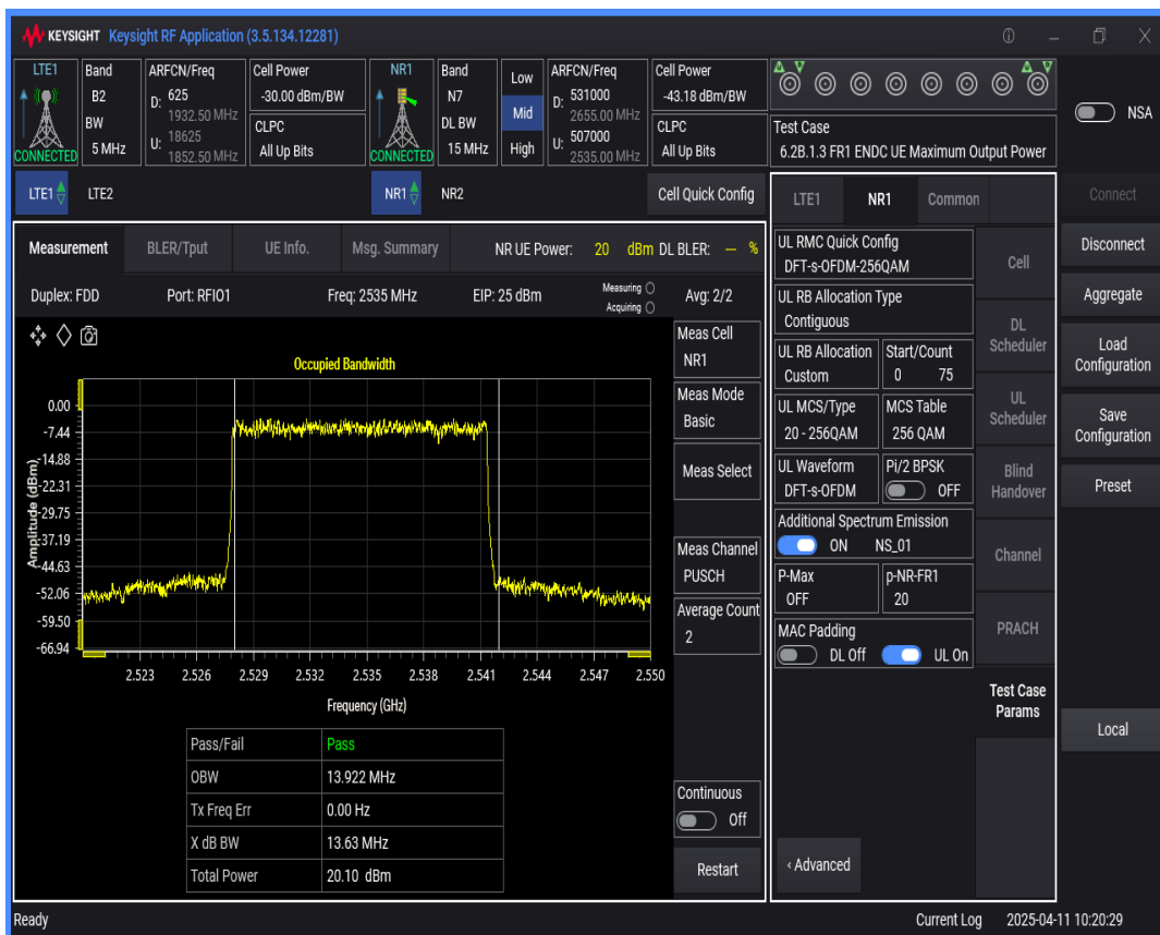
n7 SCS=30kHz DFT_BPSK BW=20MHz Channel=507000 RB=50@0
