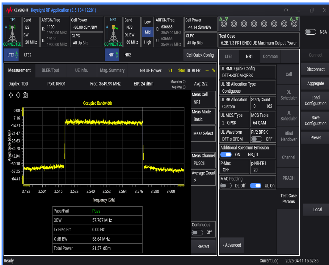
n78 SCS=30kHz DFT_QPSK BW=40MHz Channel=636666 RB=100 @0
