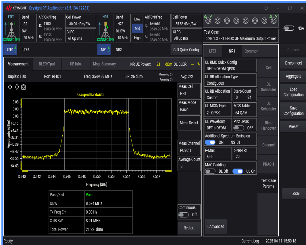
n78 SCS=30kHz DFT_QPSK BW=20MHz Channel=636666 RB=50@0
