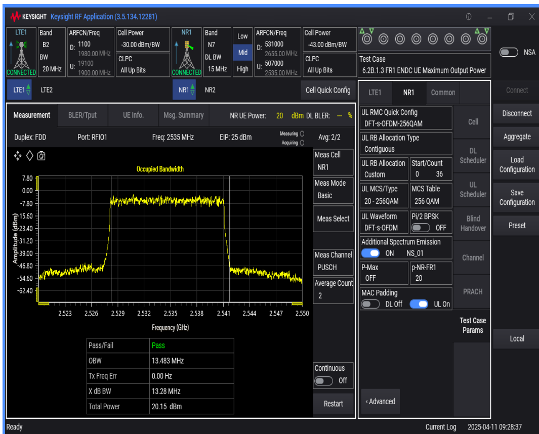
n7 SCS=30kHz DFT_QAM256 BW=10MHz Channel=507000 RB=24@0
