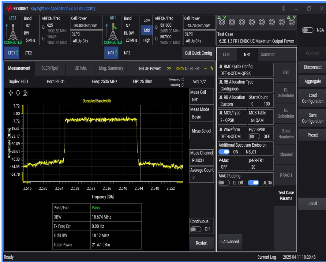
n7 SCS=15kHz DFT_QPSK BW=15MHz Channel=507000 RB=75 @0
