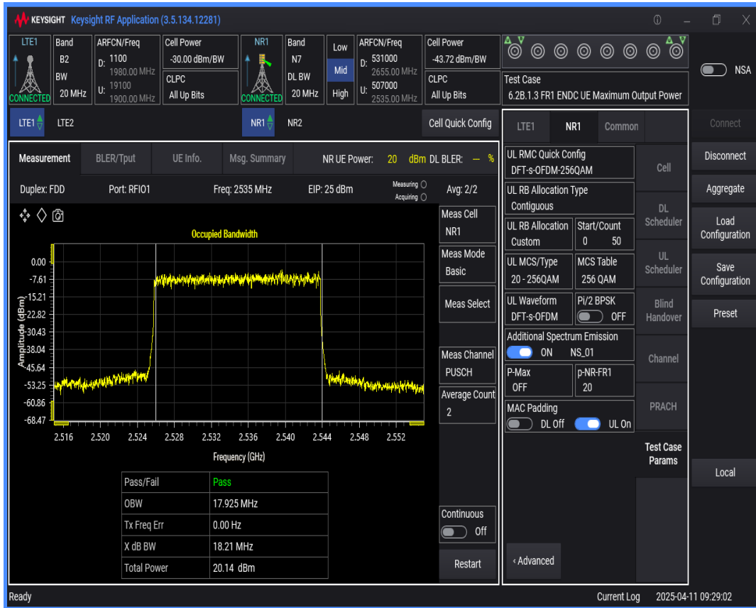
n7 SCS=30kHz DFT_QAM16 BW=20MHz Channel=507000 RB=50@0
