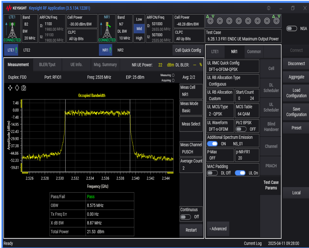
n7 SCS=30kHz DFT_QAM64 BW=20MHz Channel=507000 RB=50@0
