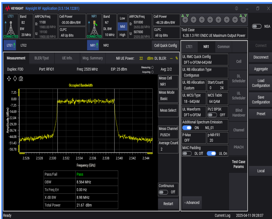
n7 SCS=30kHz DFT_QPSK BW=10MHz Channel=507000 RB=24@0
