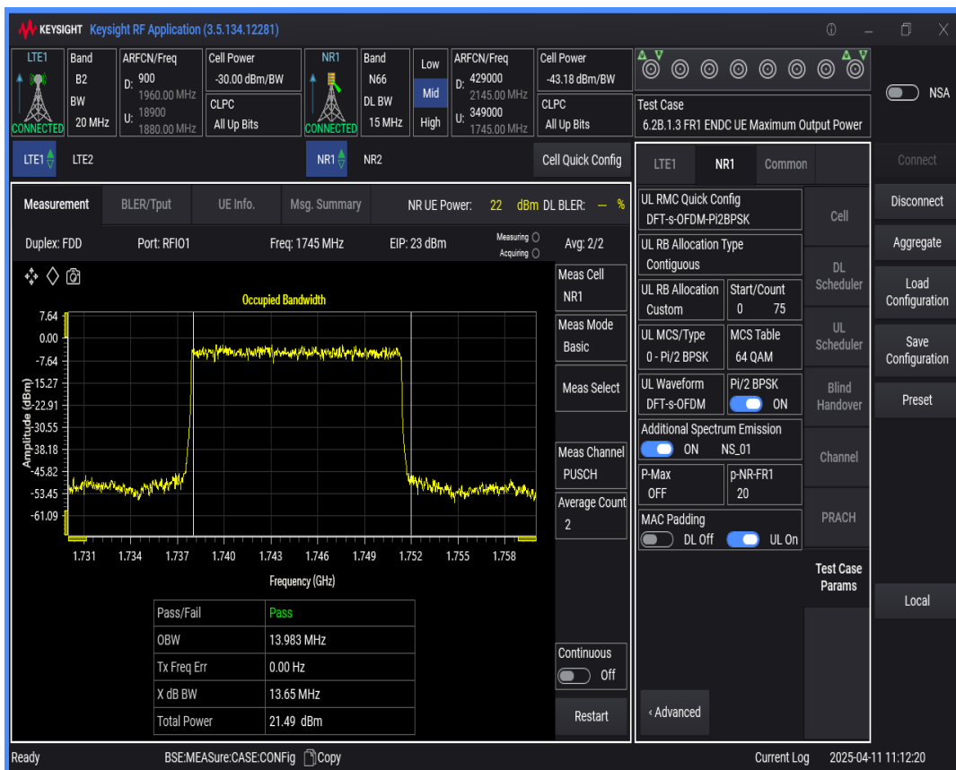
n66 SCS=15kHz DFT_BPSK BW=20MHz Channel=349000 RB=100@0
