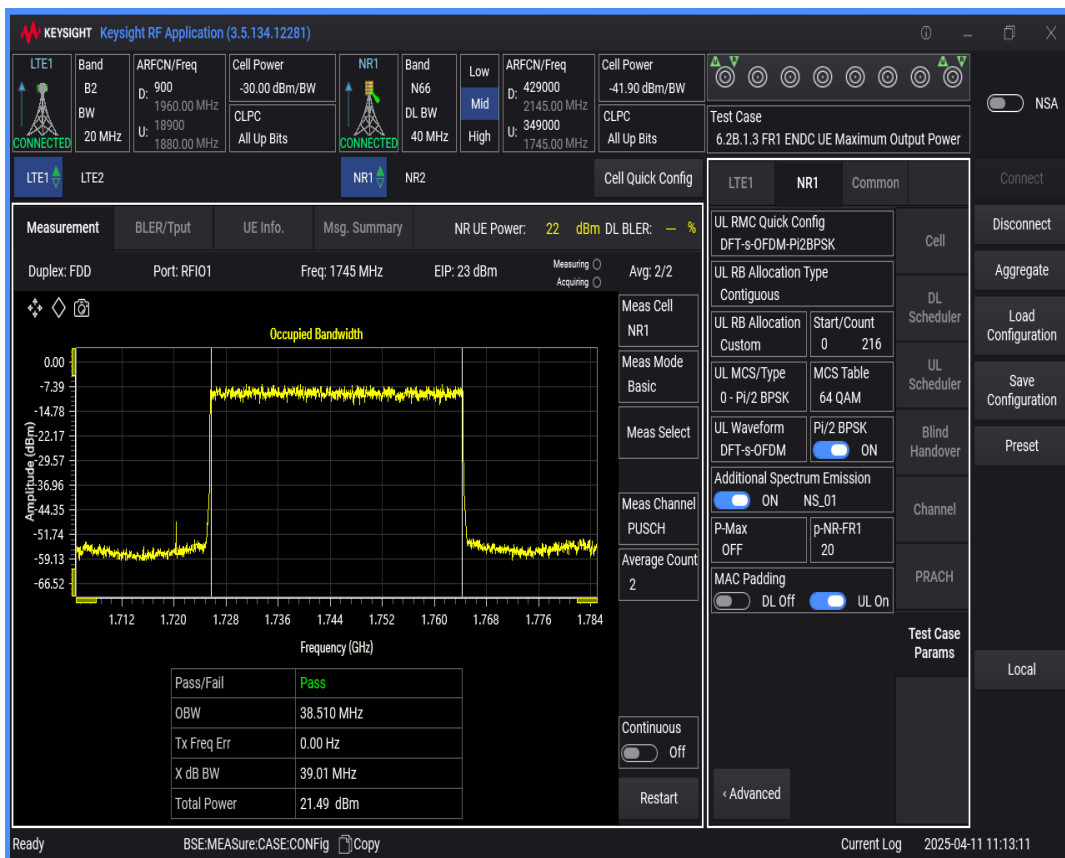
n66 SCS=15kHz DFT_BPSK BW=10MHz Channel=349000 RB=50@0
