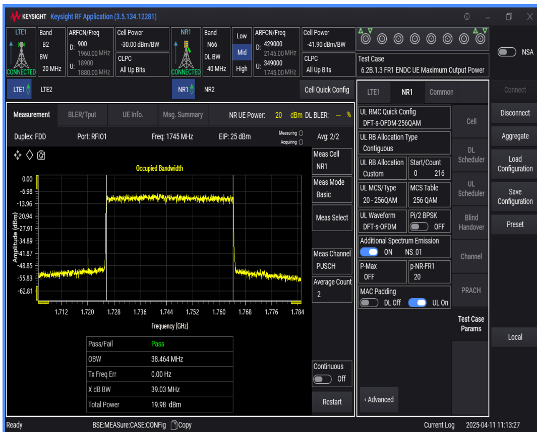
n66 SCS=15kHz DFT_QAM256 BW=20MHz Channel=349000 RB=100@0
