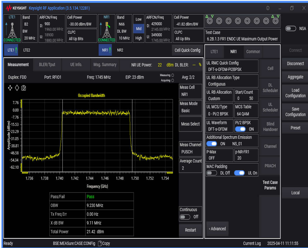
n66 SCS=15kHz DFT_BPSK BW=15MHz Channel=349000 RB=75@0
