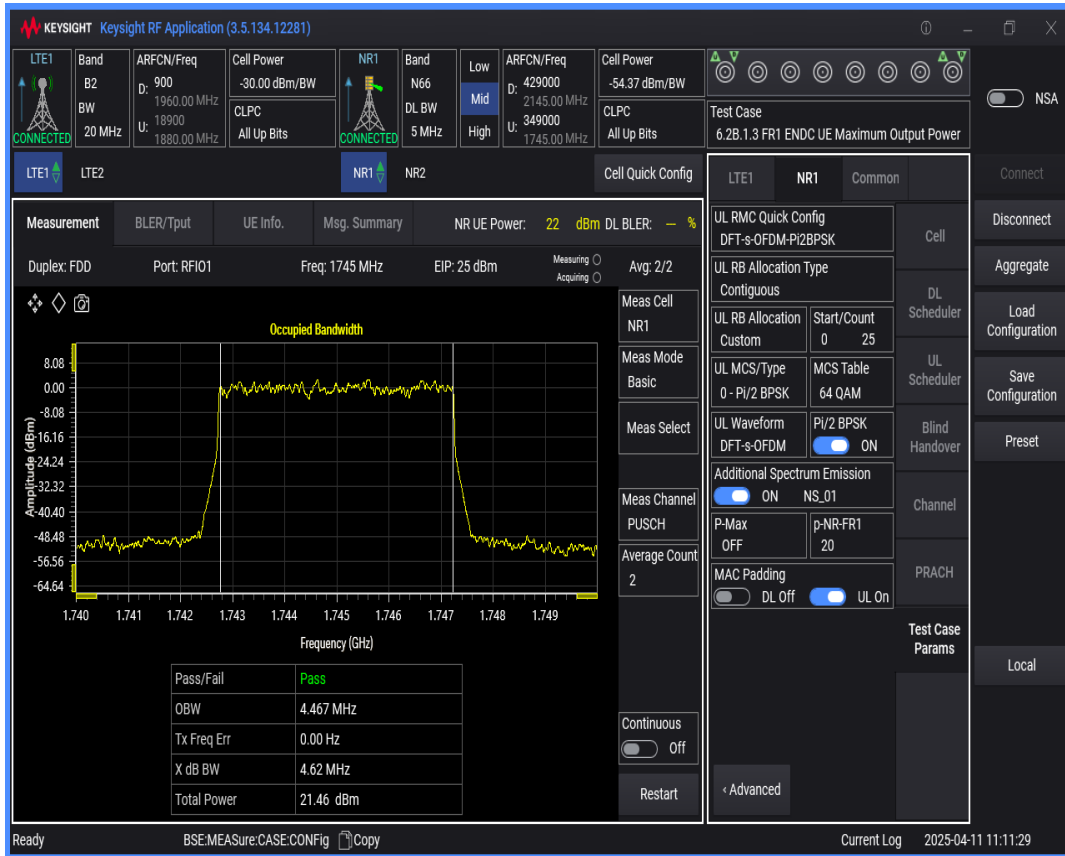
n66 SCS=15kHz DFT_QAM16 BW=10MHz Channel=349000 RB=50@0
