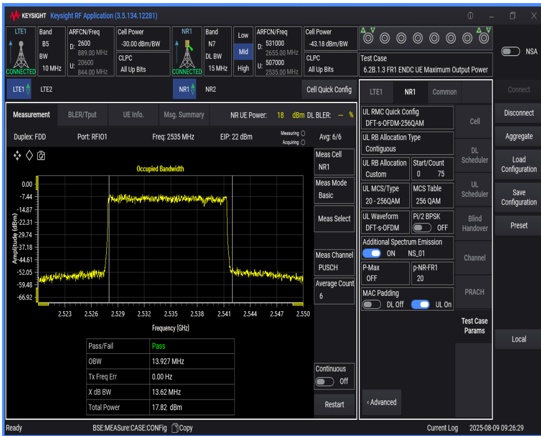
n7 SCS=15kHz DFT_QAM64 BW=10MHz Channel=507000 RB=50@0
