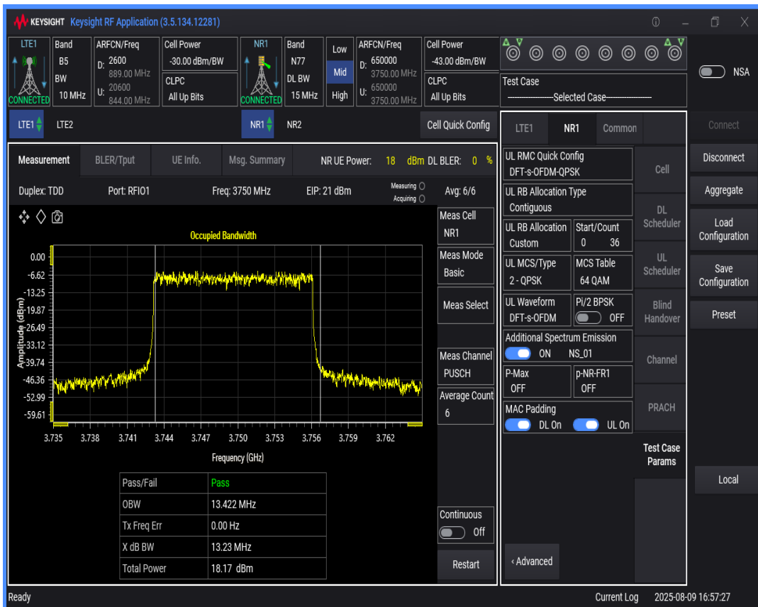
n77 SCS=30kHz DFT_QPSK BW=20MHz Channel=650000 RB=50@0
