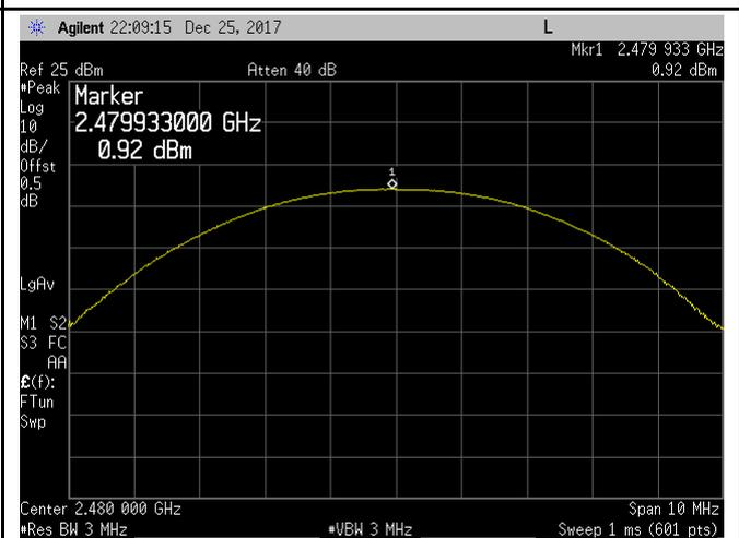
$\pi/4$  DQPSK Output power - High CH 2480
