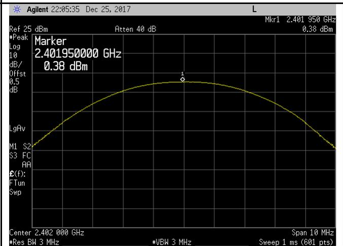
$\pi/4$  DQPSK Output power - Low CH 2402
