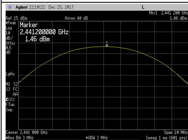
$\pi/4$  DQPSK Output power - Mid CH 2441
