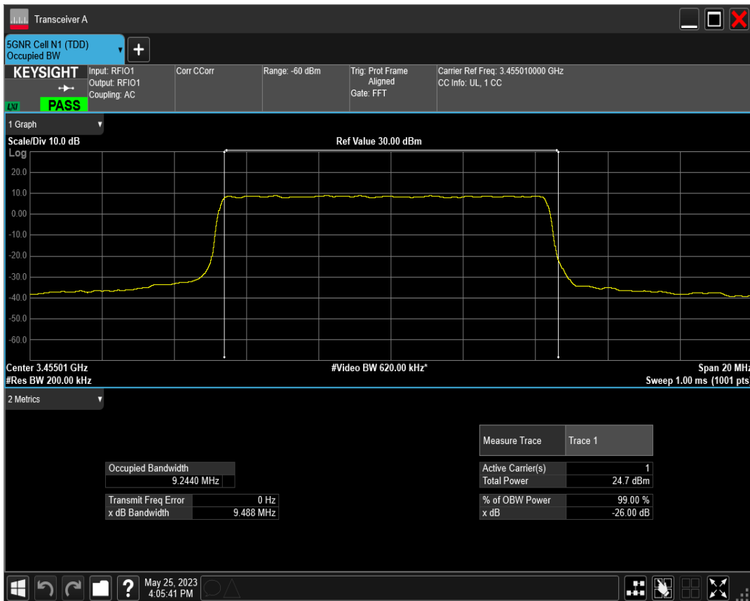
n77(3450-3550) SCS=15kHz DFT_QPSK BW=10MHz Channel=630334 RB=50@0
