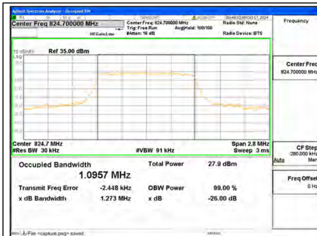
B5 / 1.4MHz / QPSK/ Low CH
