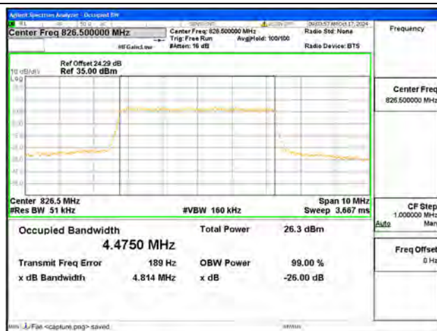
B5 / 5MHz / 64QAM/ Low CH
