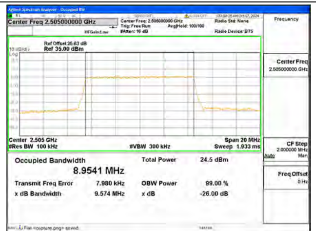
B7 / 10MHz / 64QAM/ Low CH
