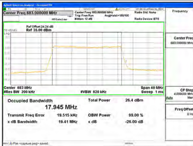
B71 / 20MHz / 64QAM/ Mid CH
