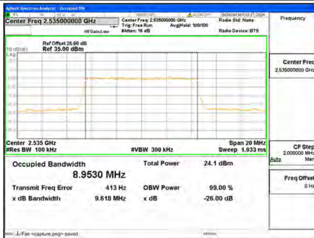
B7 / 10MHz / 64QAM/ Mid CH
