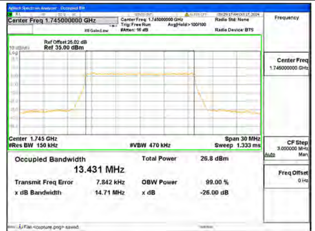
B66 / 15MHz / QPSK/ Mid CH
