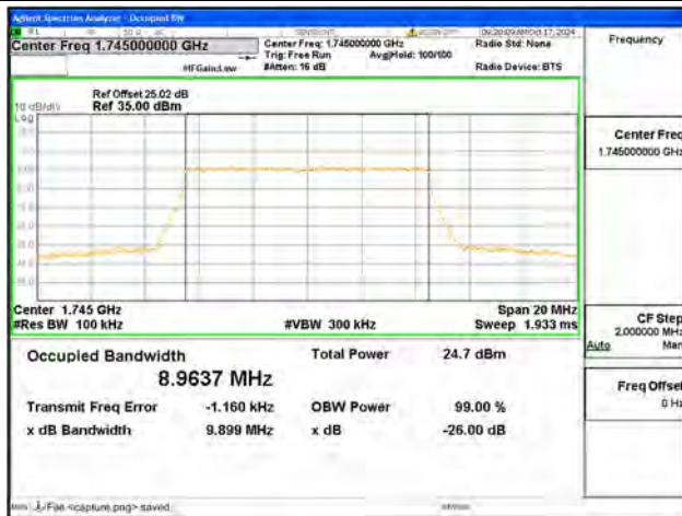
B66 / 10MHz / 64QAM/ Mid CH
