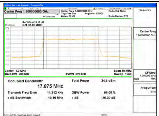
B2 / 20MHz / 64QAM/ High CH
