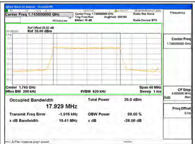
B66 / 20MHz / 16QAM/ Mid CH
