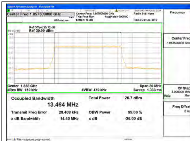
B2 / 15MHz / QPSK/ Low CH
