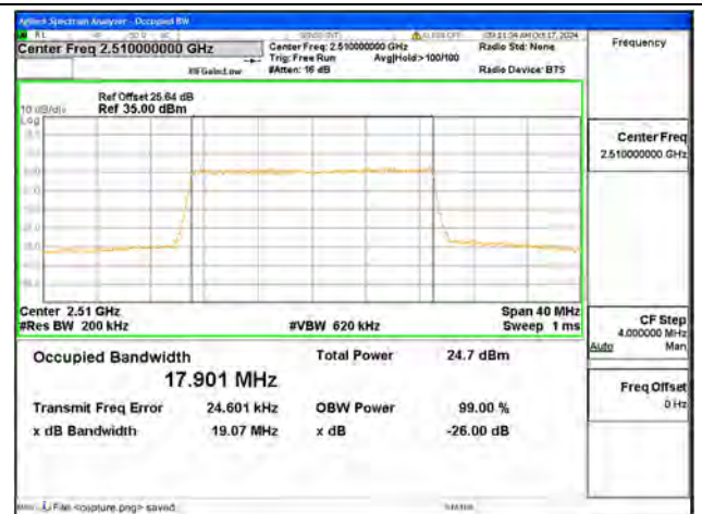
B7 / 20MHz / 64QAM/ Low CH
