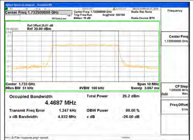
B4 / 5MHz / QPSK/ Mid CH
