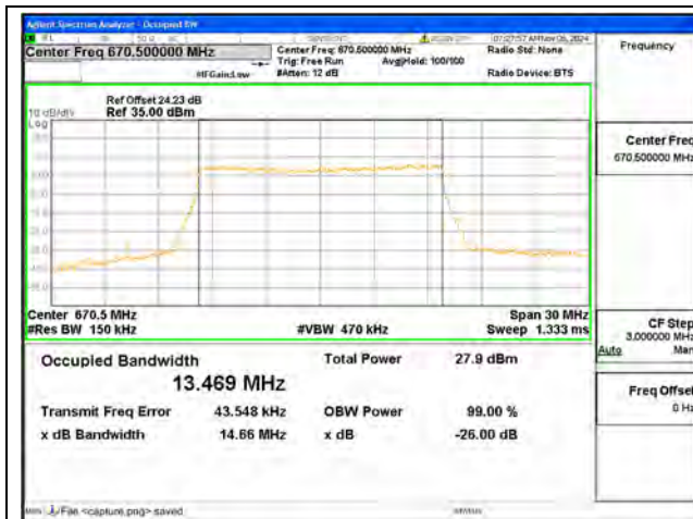
B71 / 15MHz / QPSK/ Low CH
