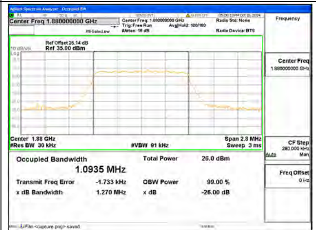
B2 / 1.4MHz / QPSK/ Mid CH
