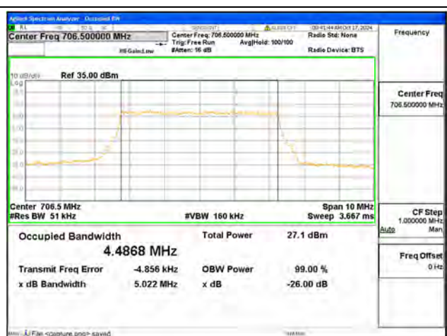
B17 / 5MHz / 16QAM/ Low CH
