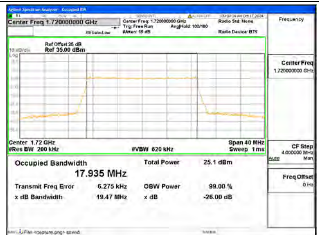
B66 / 20MHz / 64QAM/ Low CH
