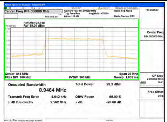
B5 / 10MHz / QPSK/ High CH
