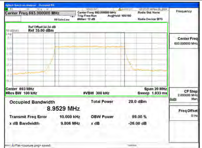
B71 / 10MHz / QPSK/ High CH
