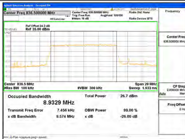
B5 / 10MHz / 64QAM/ Mid CH
