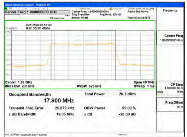
B2 / 20MHz / QPSK/ Low CH
