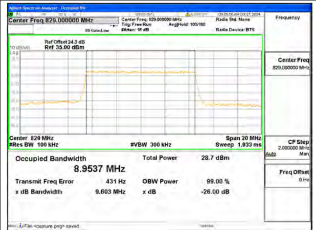
B5 / 10MHz / QPSK/ Low CH
