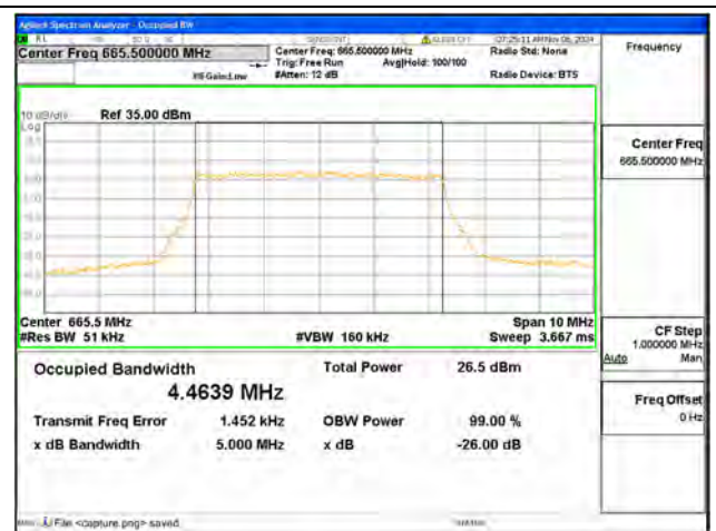
B71 / 5MHz / 16QAM/ Low CH
