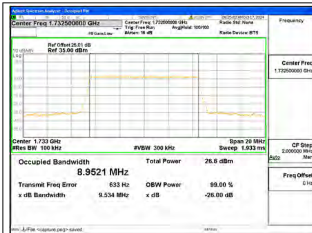
B4 / 10MHz / QPSK/ Mid CH
