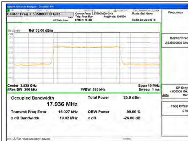
B7 / 20MHz / QPSK/ Mid CH
