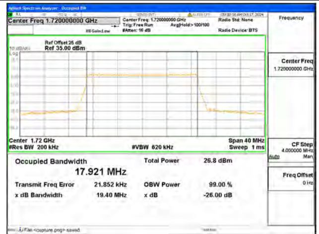
B66 / 20MHz / QPSK/ Low CH
