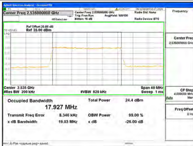
B7 / 20MHz / 64QAM/ Mid CH
