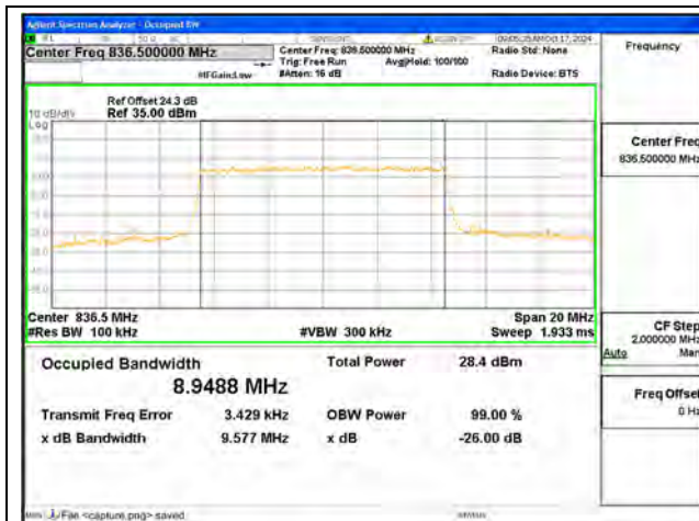
B5 / 10MHz / QPSK/ Mid CH
