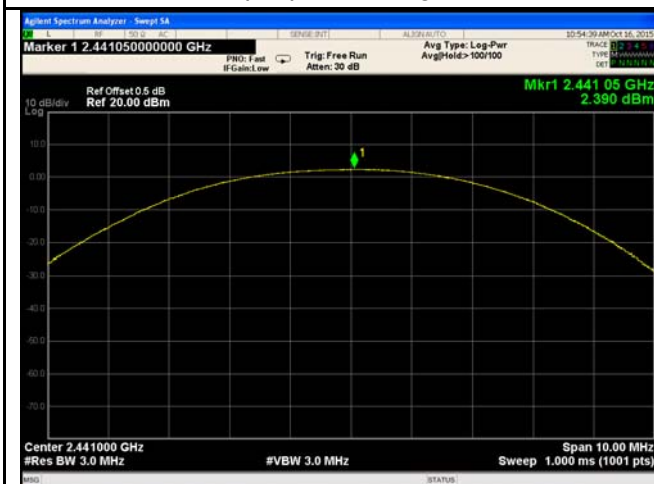
\pi/4 DQPSK Output power - Mid CH 2441
