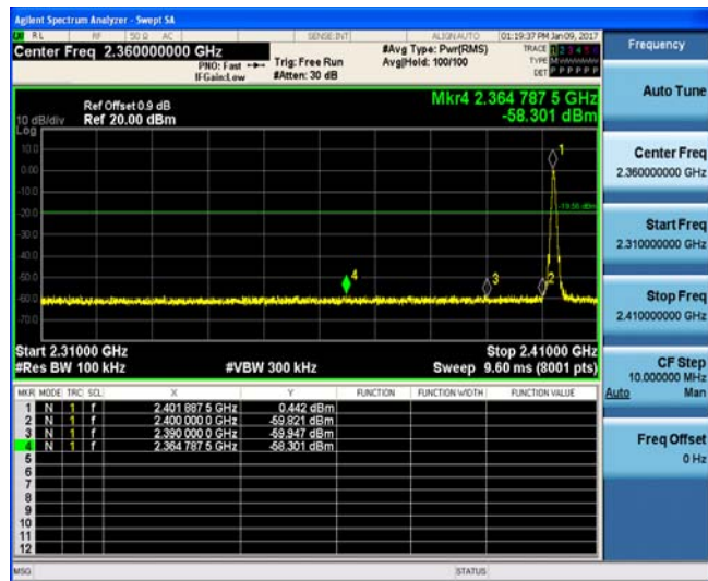
Left Band edge hopping off
