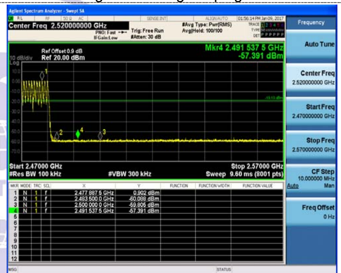
Right Band edge hopping on
