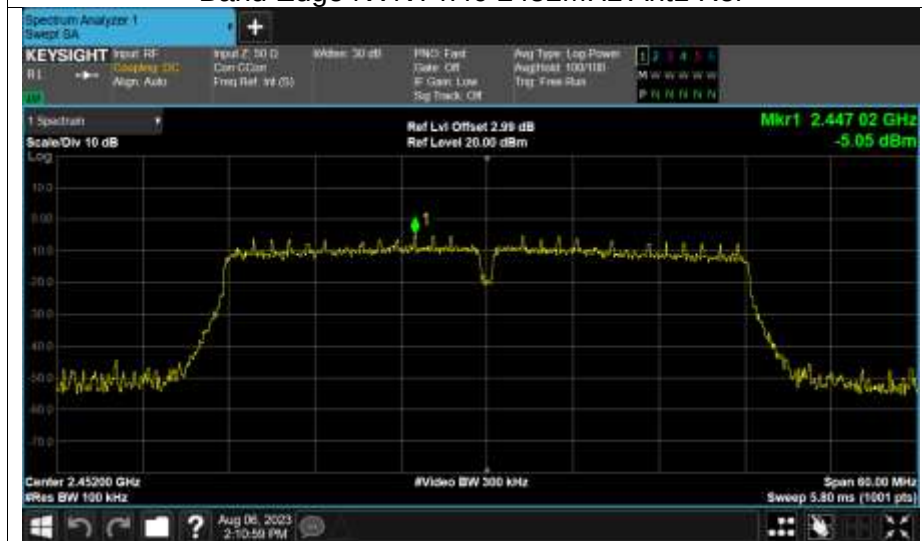
Band Edge NVNT n40 2452MHz Ant1 Ref
