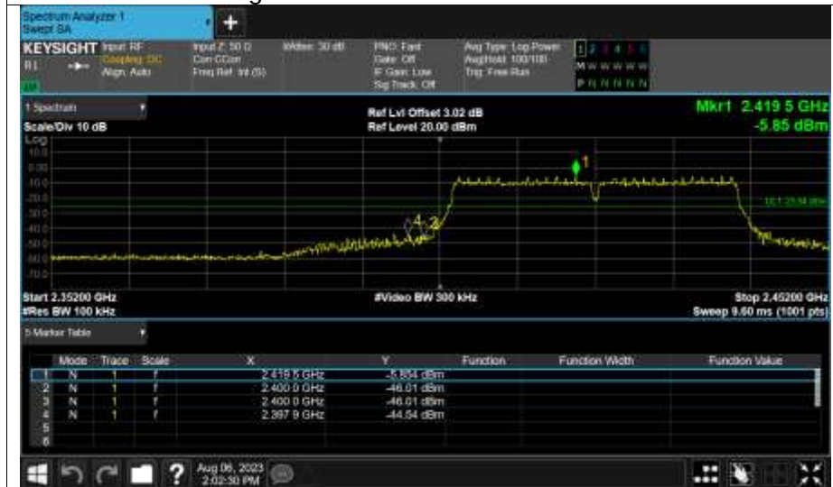
Band Edge NVNT n40 2452MHz Ant1 Ref
