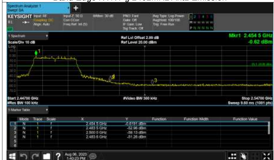
Band Edge NVNT n20 2412MHz Ant1 Ref
