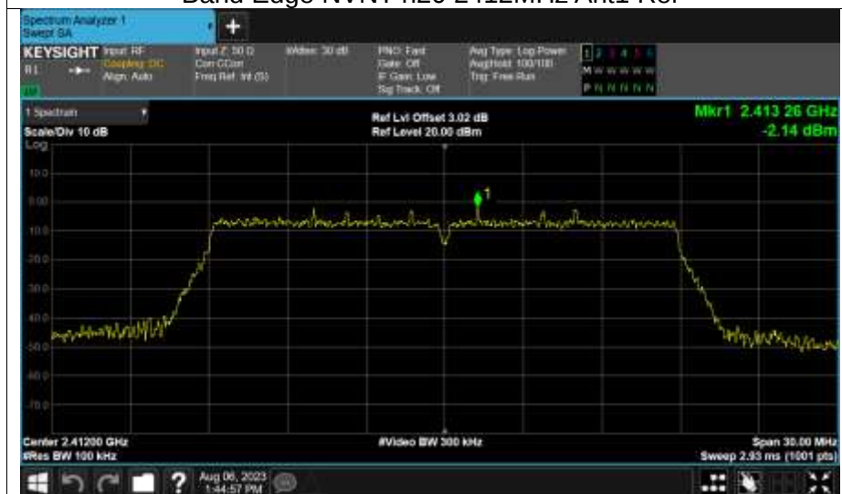
Band Edge NVNT n20 2412MHz Ant1 Ref
