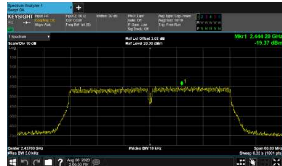
PSD NVNT n40 2452MHz Ant1
