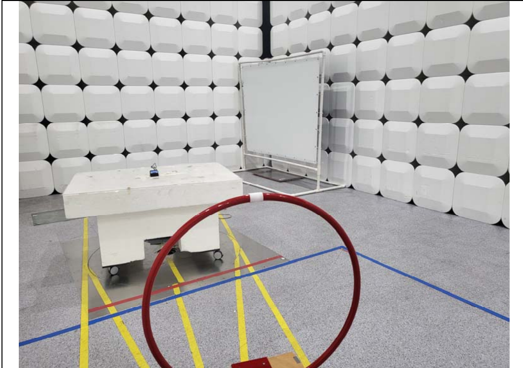
Test distance : 3 m, height of table : 0.8 m
