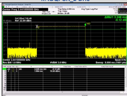
Pulse Width \pi/4 DQPSK 2-DH5
