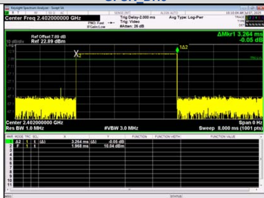
Pulse Width \pi/4 DQPSK 2-DH5
