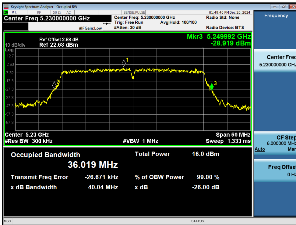
-26dB Bandwidth NVNT ac40 5230MHz Ant1
