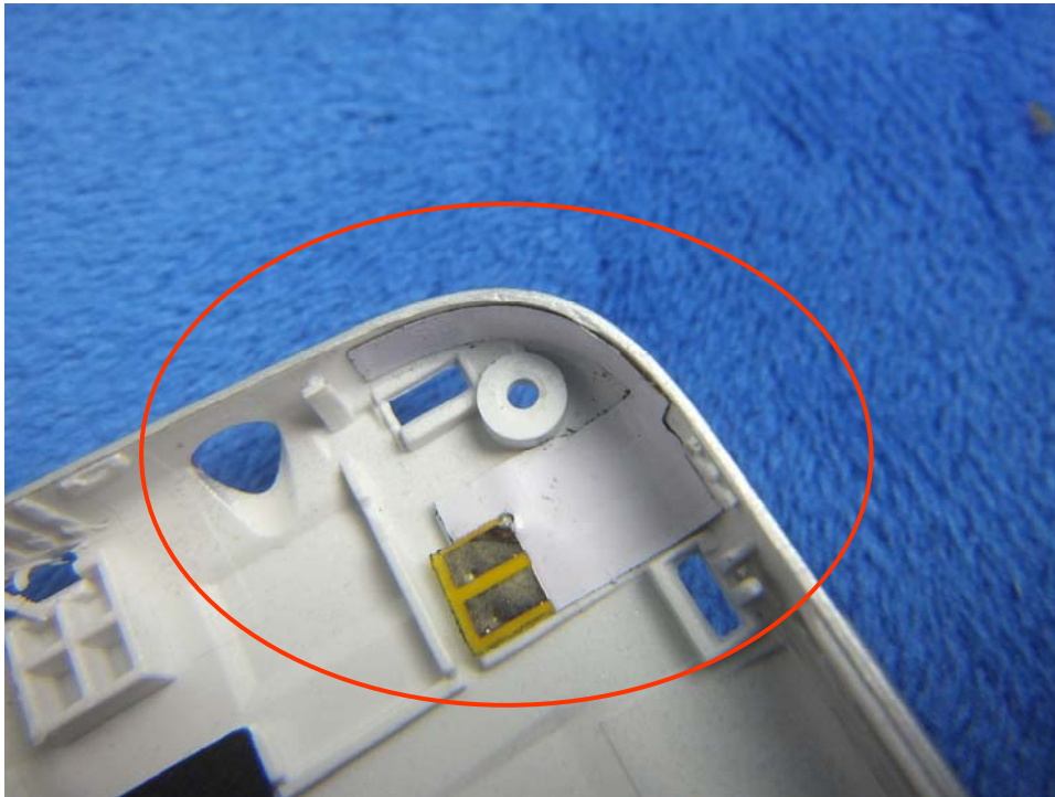
BT/WIFI/GPS - Antenna View
