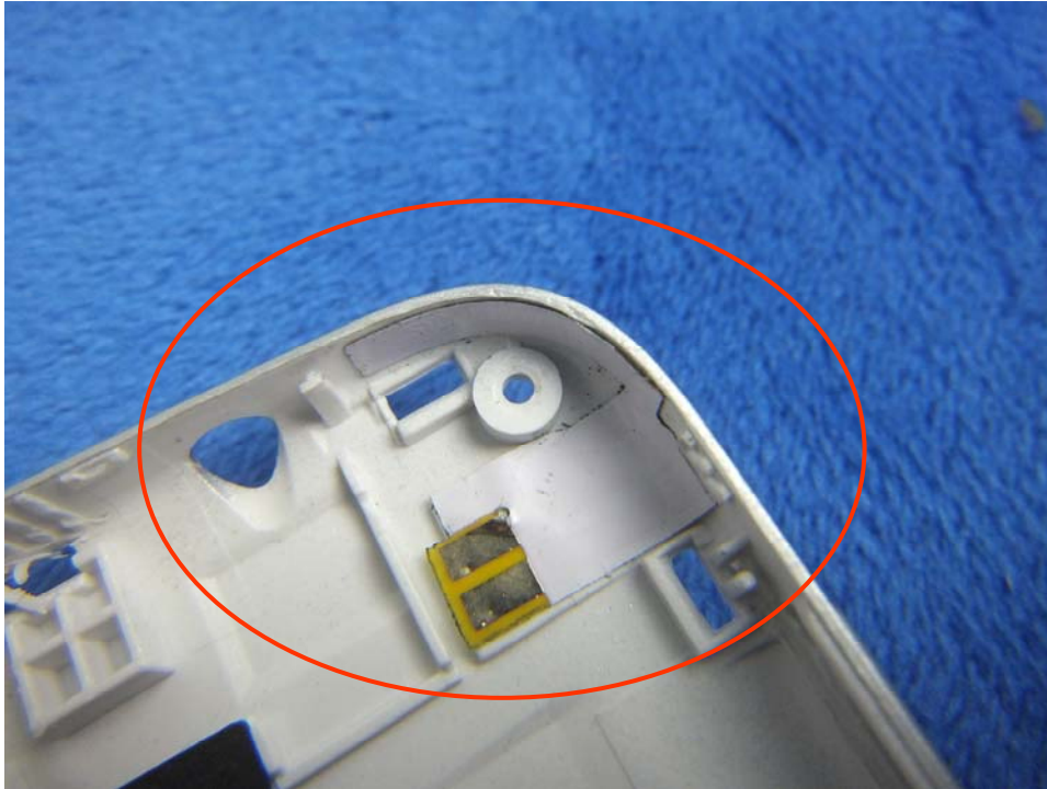
BT/WIFI/GPS - Antenna View
