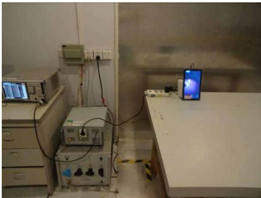
**RADIATED EMISSION TEST BLOW 1GHz**
