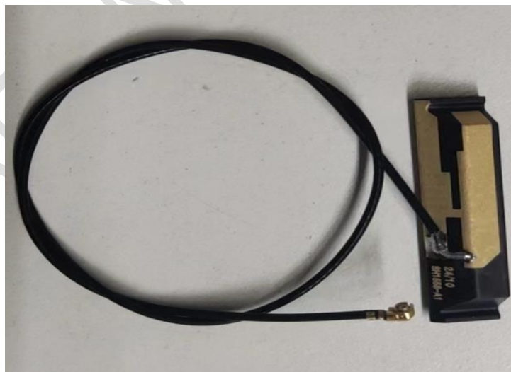
图 1 天线图片/ Figure 1: Antenna image
