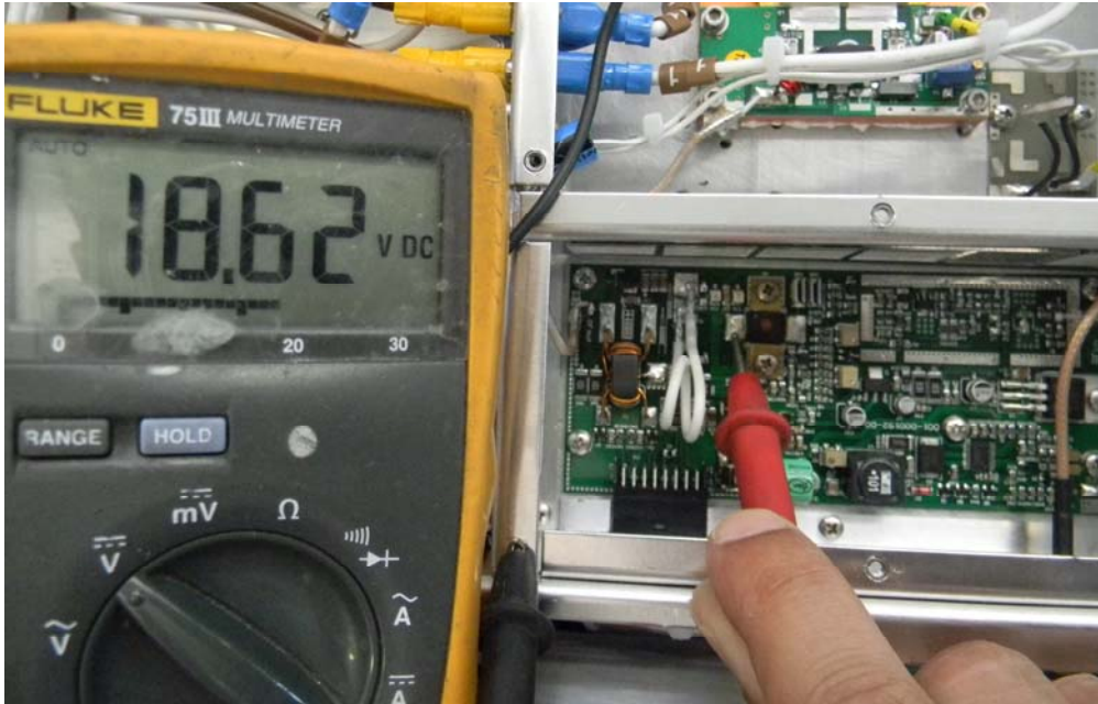
Fig. 15 – 30W RF module RT4 adjust
