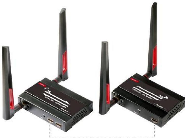
ペアリング方法：製品の電源を 25 秒間入れた後、HD ケーブルで TX 入力と RX 出力に接続して、10 秒間待ってから、電源を抜いてから電源を入れてください。
