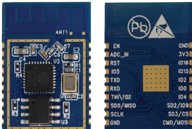
Figure 1-1. ESP-WROOM-S2 Module
