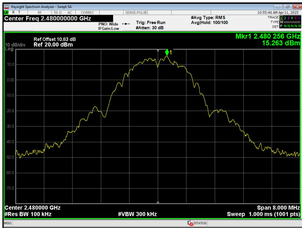
**Band Edge Zigbee 2480MHz Emission**
