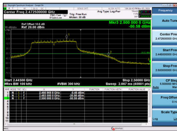
,Plot 2,Band Edge-802.11n(HT20) ,2462MHz,Ant0
