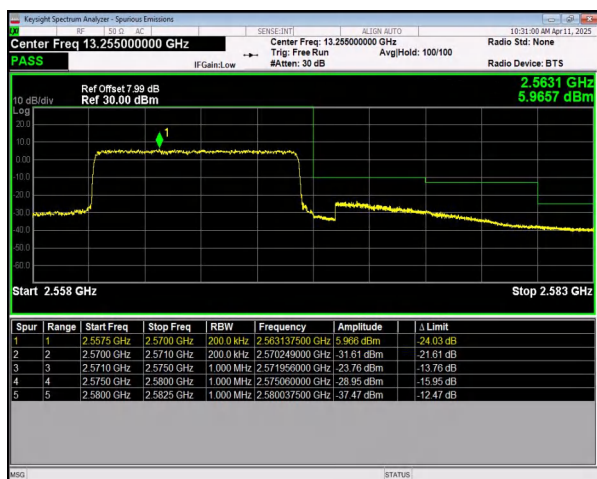
n7 SCS=15kHz DFT_64QAM BW=10MHz HighChannel=513000 RB=50@0
