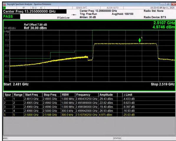
n7 SCS=15kHz CP_QPSK BW=15MHz LowChannel=501500 RB=79@0
