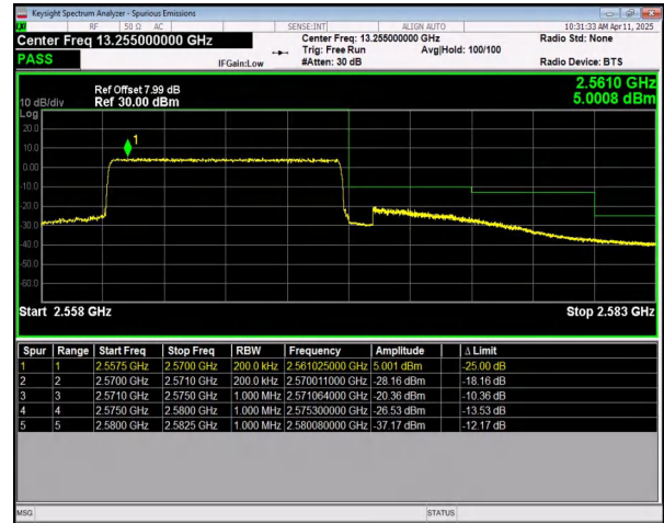
n7 SCS=15kHz CP_QPSK BW=10MHz HighChannel=513000 RB=52@0
