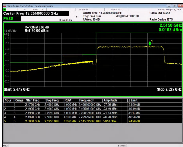
n7 SCS=15kHz CP_QPSK BW=20MHz LowChannel=502000 RB=106@0
