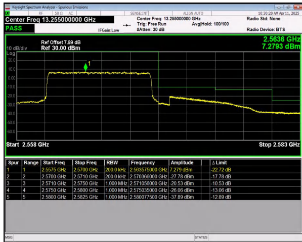
n7 SCS=15kHz DFT_QPSK BW=10MHz HighChannel=513000 RB=50@0
