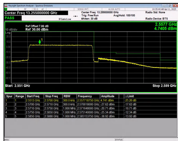
n7 SCS=15kHz CP_QPSK BW=15MHz HighChannel=512500 RB=79@0
