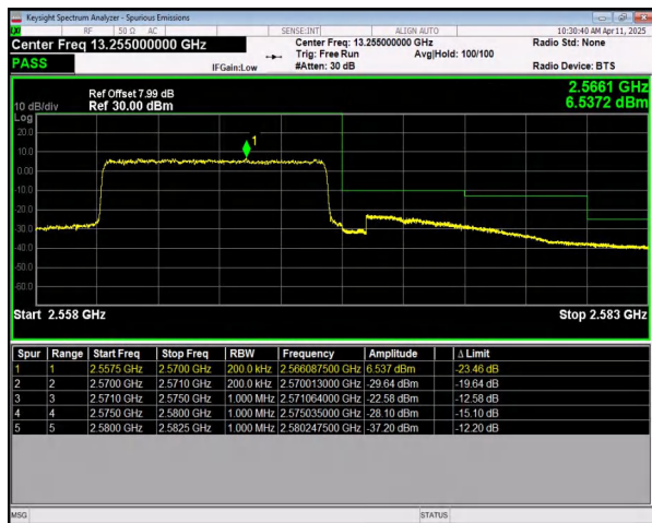
n7 SCS=15kHz DFT_16QAM BW=10MHz HighChannel=513000 RB=50@0
