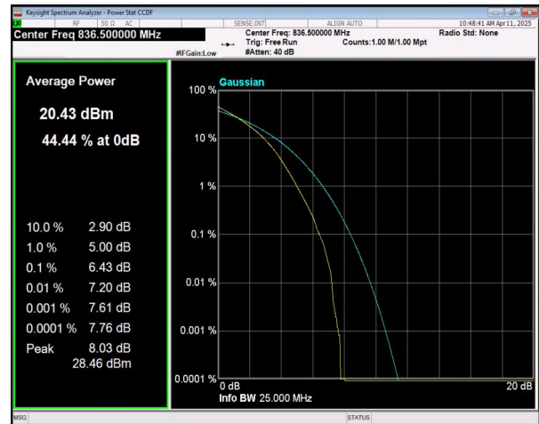
n26(824-849) SCS=15kHz DFT_64QAM BW=20MHz Channel=167300 RB=100@0
