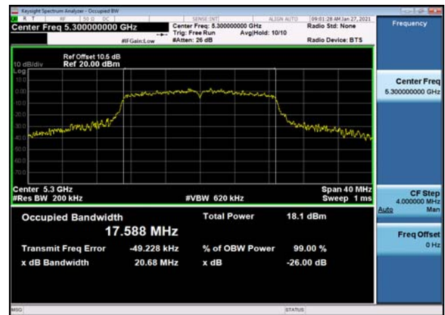
U-NII-2a 26dB Bandwidth-802.11n(40MHz )5270MHz,Ant1
