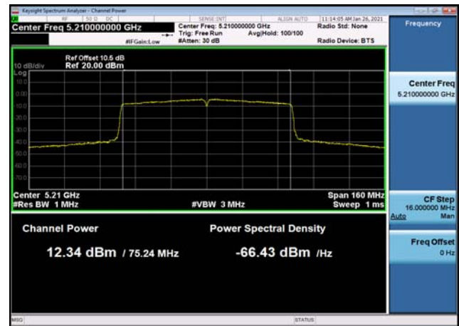
U-NII-2a Output Power-802.11n(20MHz) ,5300MHz,Ant1
