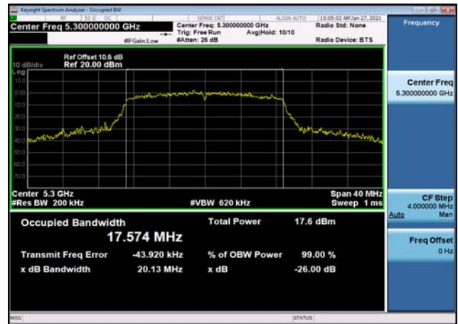
U-NII-2a 26dB Bandwidth-802.11ac(40MHz),5270MHz,Ant1
