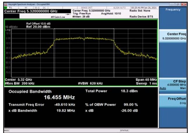
U-NII-2a 26dB Bandwidth-802.11ac(20MHz),5300MHz,Ant1
