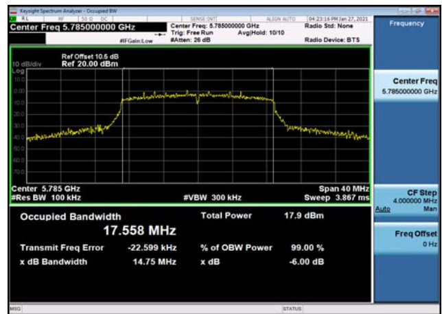
U-NII-3 6dB Bandwidth-802.11n(40MHz) ,5755MHz,Ant1
