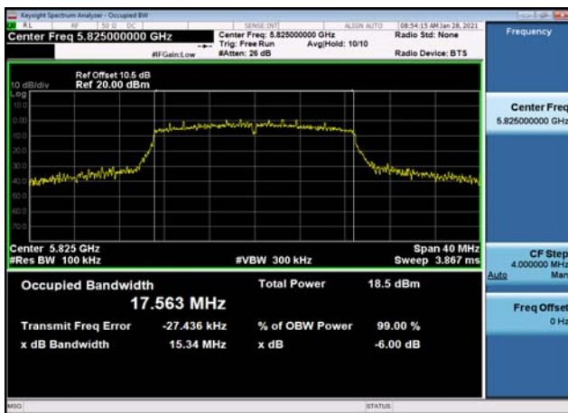
U-NII-3 6dB Bandwidth-802.11ac(20MHz) ,5825MHz,Ant1
