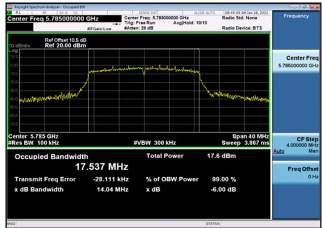
U-NII-3 6dB Bandwidth-802.11ac(40MHz) ,5755MHz,Ant1
