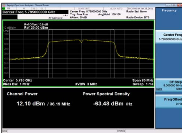
U-NII-3 Output Power-802.11ac(40MHz) ,5795MHz,Ant1
