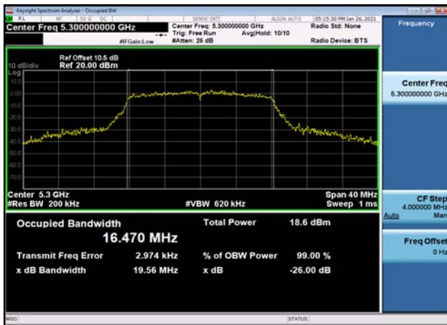
U-NII-2a 26dB Bandwidth-802.11ac(20MHz),5260MHz,Ant1
