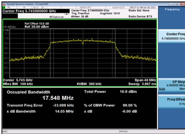
U-NII-3 6dB Bandwidth-802.11ac(20MHz) ,5825MHz,Ant1
