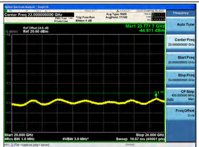
Band40-1-20G-24G / 5MHz / Low CH / QPSK
