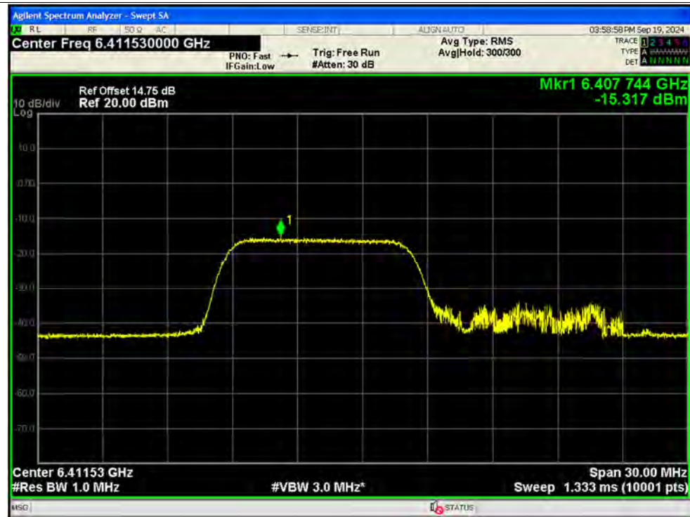
PSD NVNT ax20 106@53 6415MHz Ant13 MIMO
