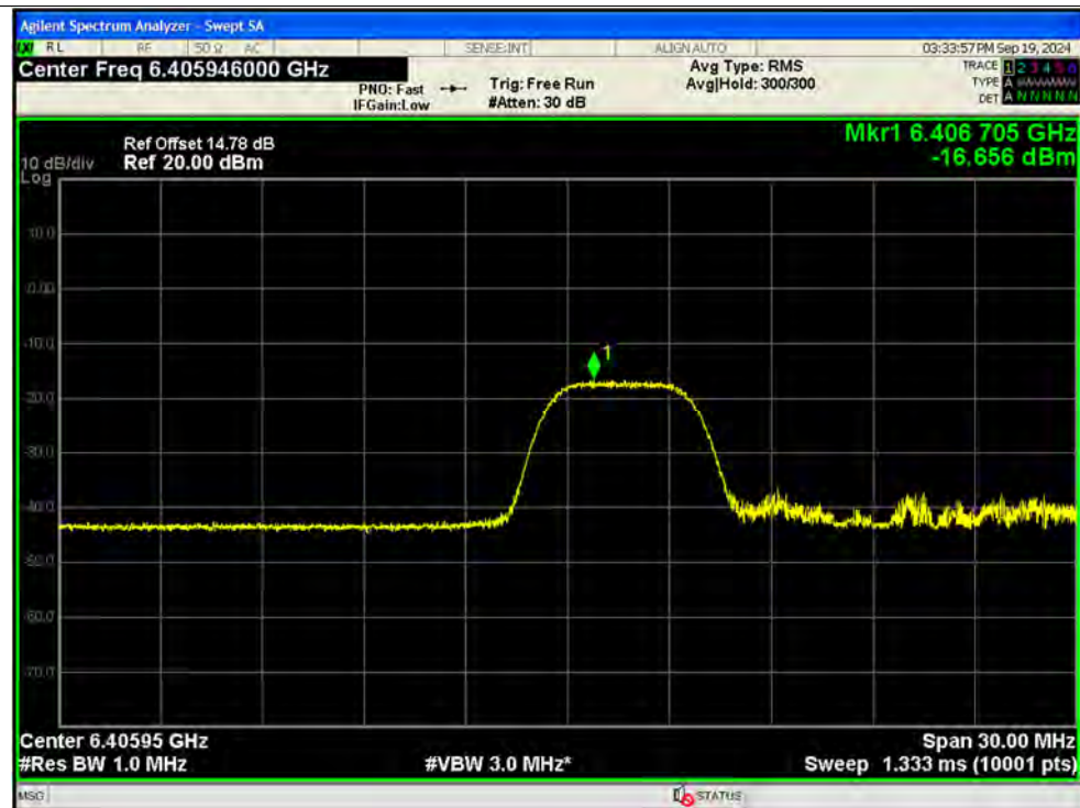
PSD NVNT ax20 52@37 6415MHz Ant13 MIMO
