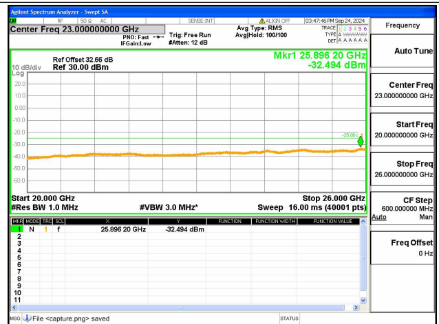
2A-7A-20G-26G / 20+20MHz / QPSK / Low+Mid CH / 1@0-1@99
