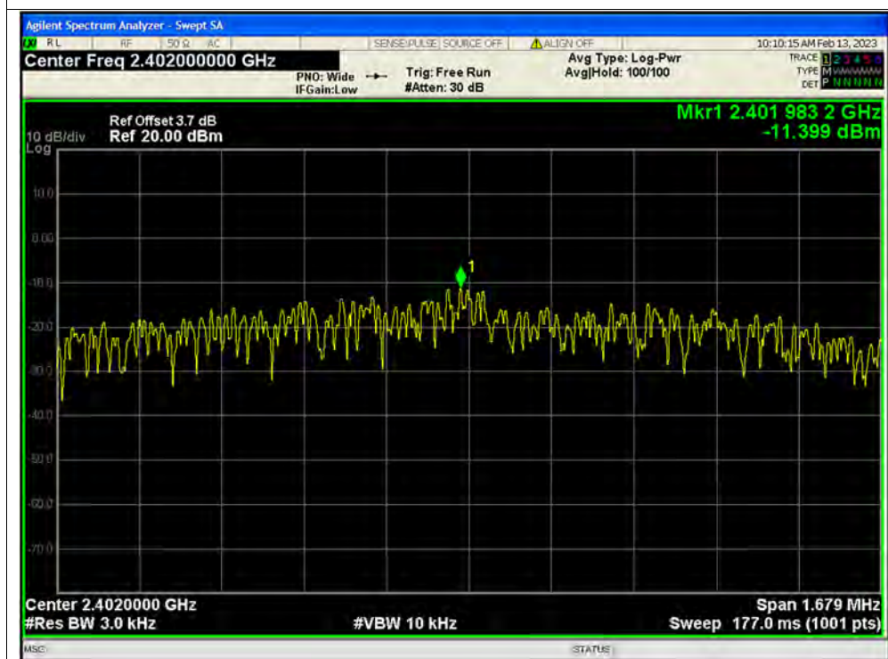
PSD NVNT BLE 2M 2402MHz Ant1
