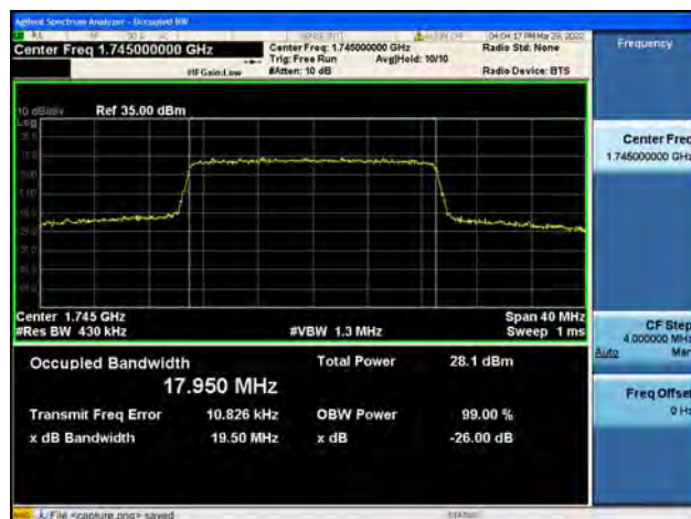
Band4 / 20MHz / High CH / QPSK
