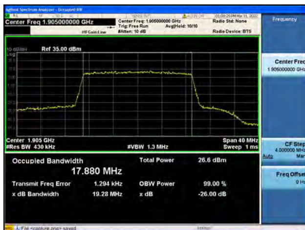
Band25 / 20MHz / High CH / QPSK
