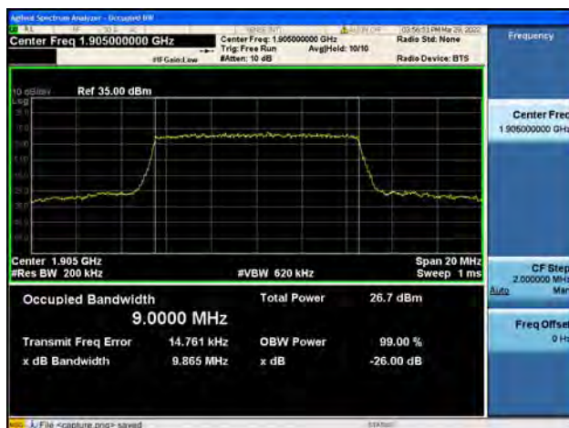
Band2 / 10MHz / High CH / QPSK
