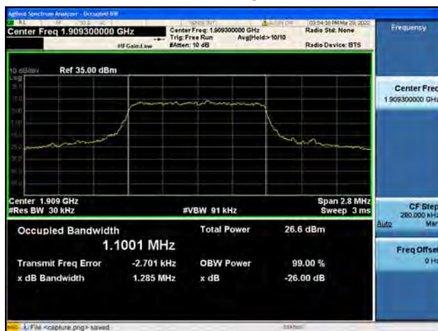
Band2 / 1.4MHz / High CH / QPSK
