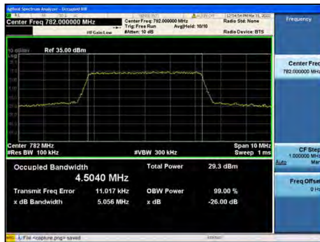
Band13 / 5MHz / High CH / QPSK
