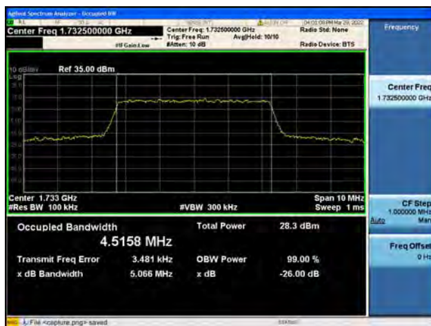
Band4 / 5MHz / High CH / QPSK
