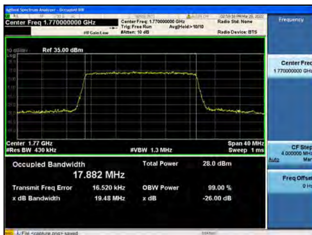
Band66 / 20MHz / High CH / QPSK
