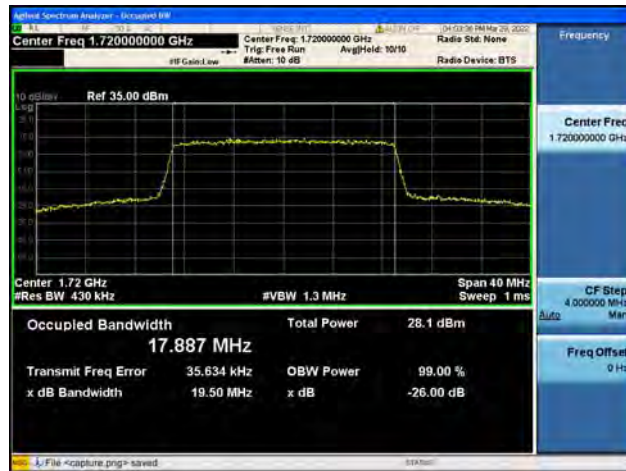
Band4 / 20MHz / Mid CH / QPSK
