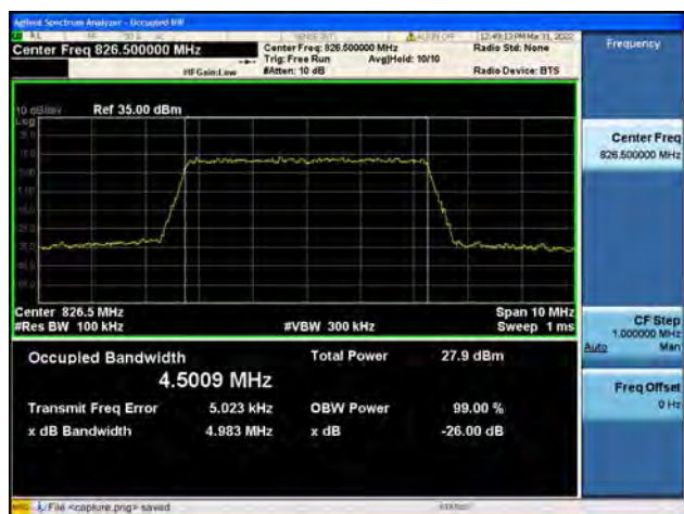
Band5 / 5MHz / Mid CH / 16QAM
