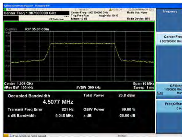
Band2 / 5MHz / High CH / QPSK
