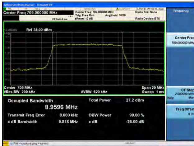
Band17 / 10MHz / Mid CH / QPSK
