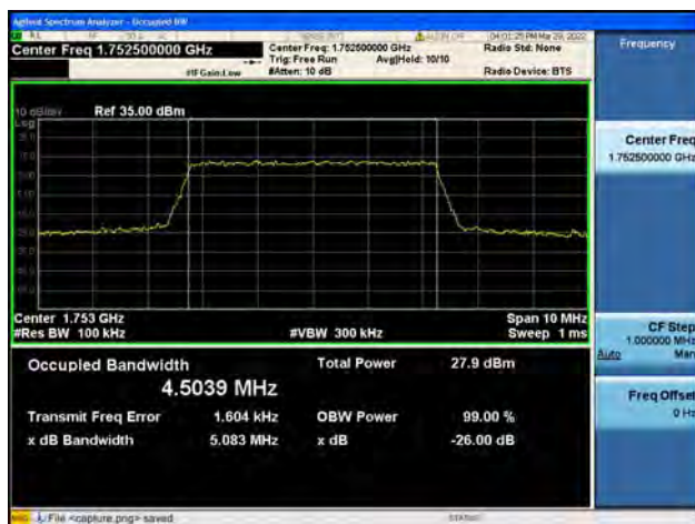
Band4 / 5MHz / High CH / QPSK
