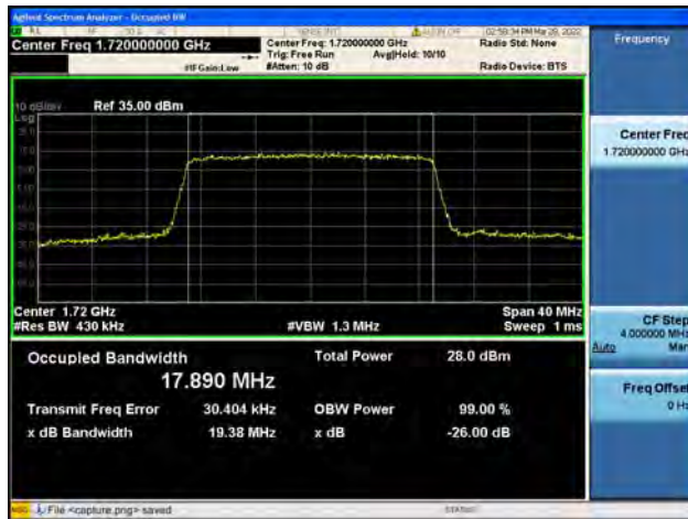
Band66 / 20MHz / Mid CH / QPSK
