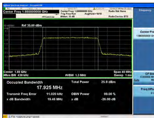
Band2 / 20MHz / High CH / 16QAM
