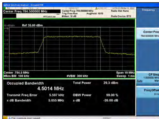
Band13 / 5MHz / High CH / QPSK
