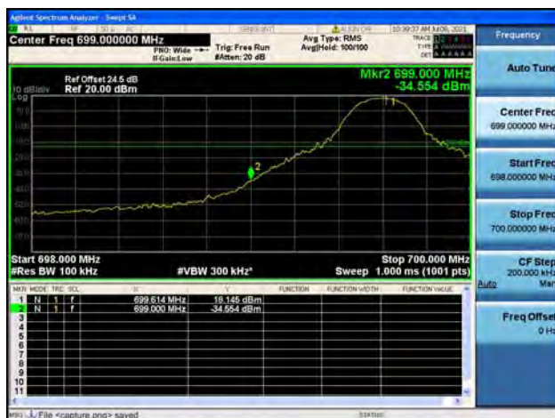
Band12 / 10MHz / Low CH / QPSK / 1 RB
