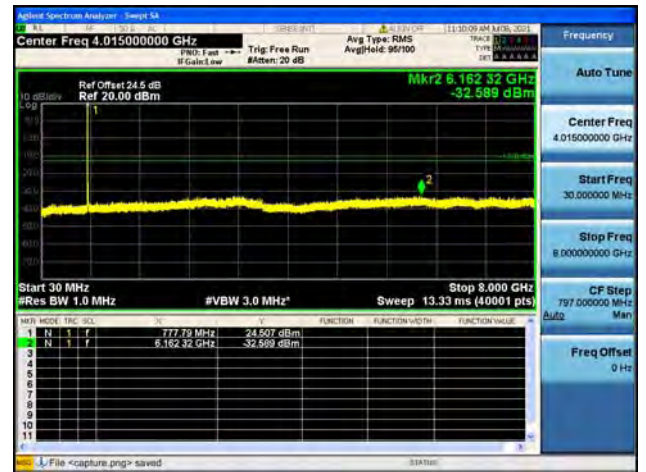
Band13 / 10MHz / Mid CH / QPSK
