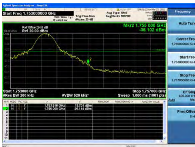
Band4 / 20MHz / High CH / QPSK / 1 RB
