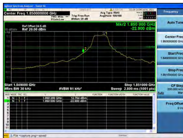
Band2 / 3MHz / Low CH / QPSK / 1 RB
