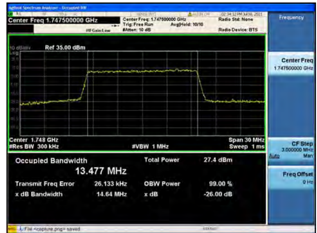
Band4 / 20MHz / Low CH / QPSK
