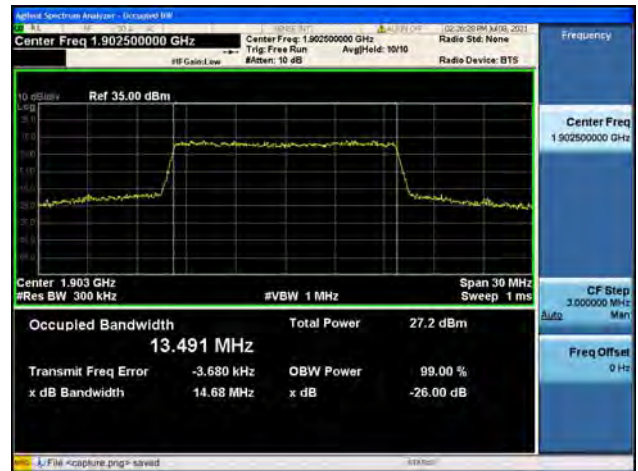
Band2 / 20MHz / Low CH / QPSK
