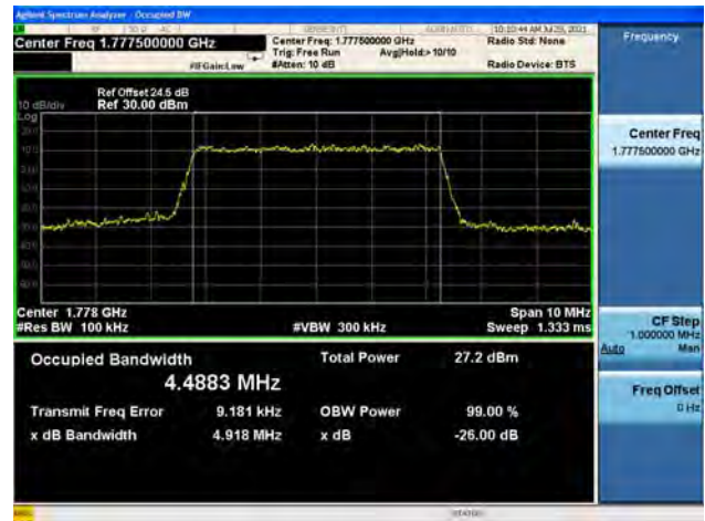
Band66 / 10MHz / Low CH / QPSK
