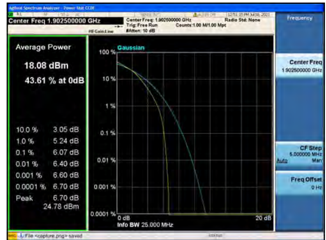
Band2 / 20MHz / Low CH / QPSK
