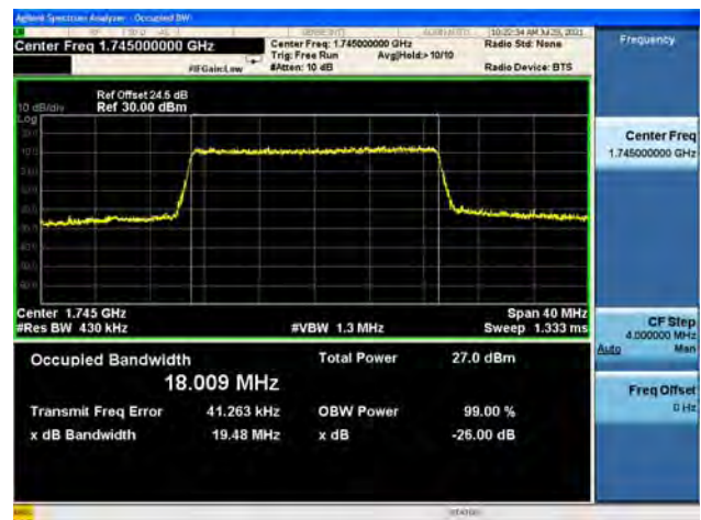
Band66 / 20MHz / High CH / QPSK
