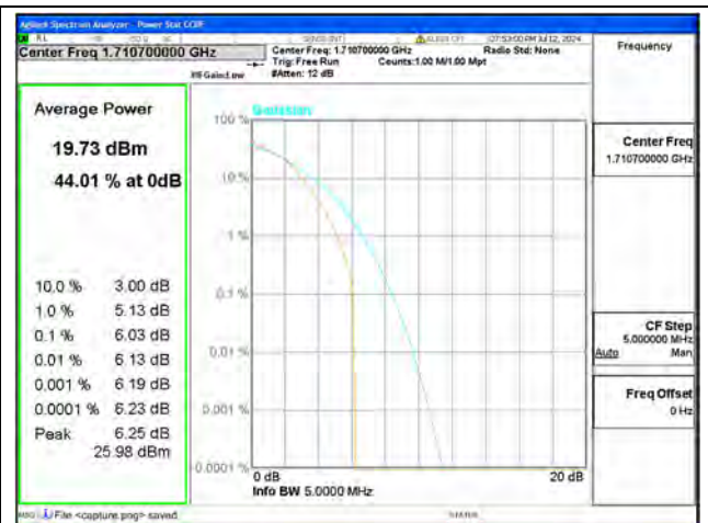
B66 / 1.4MHz / Low CH / 16QAM
