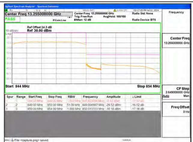
B5 / 5MHz / High CH / QPSK / FULL RB
