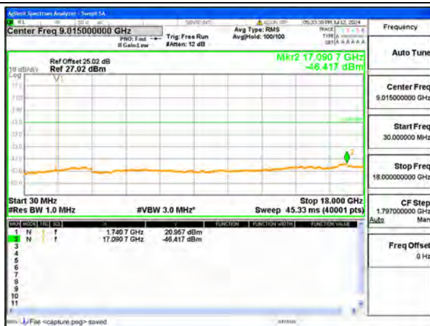
B66 / 10MHz / Mid CH / QPSK
