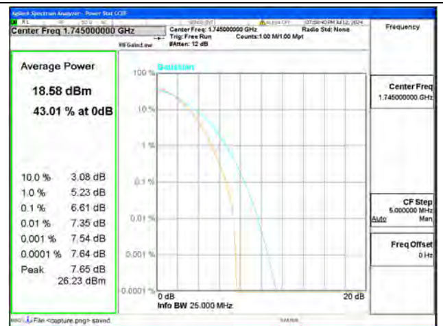
B66 / 15MHz / Mid CH / 64QAM
