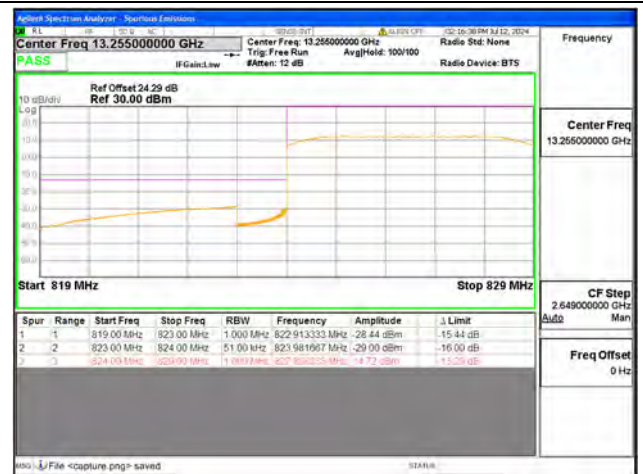
B5 / 5MHz / Low CH / QPSK / FULL RB
