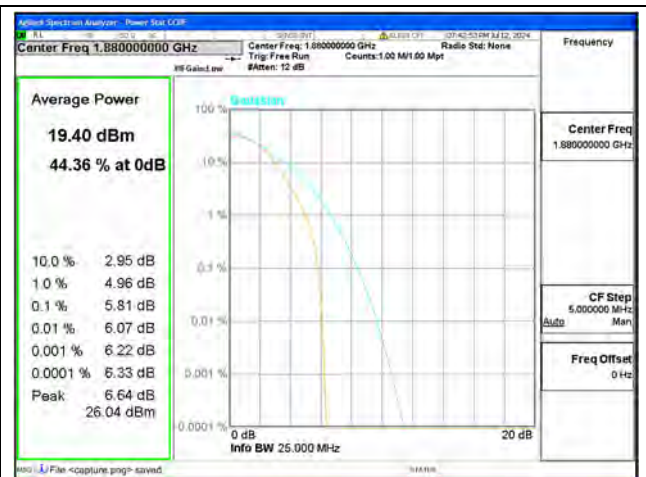
B2 / 20MHz / Mid CH / 16QAM
