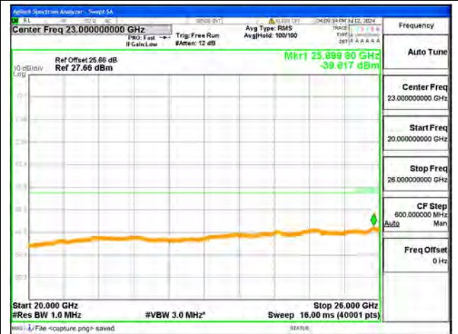
B7-20G-26G / 20MHz / Mid CH / QPSK
