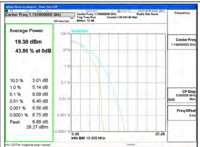
B66 / 10MHz / Mid CH / 16QAM
