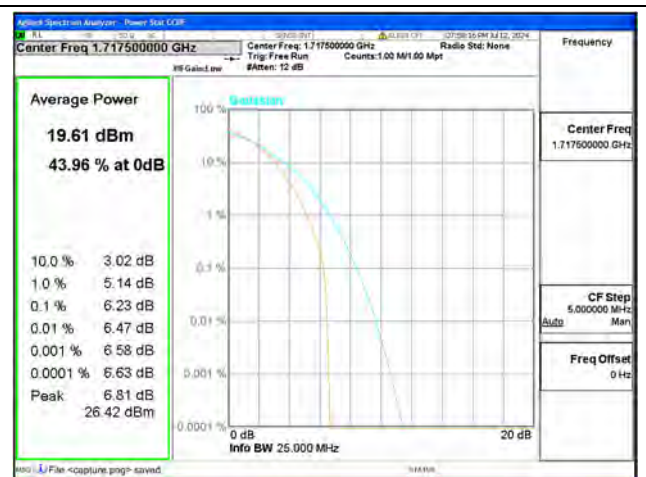
B66 / 15MHz / Low CH / 16QAM
