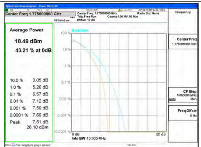
B66 / 10MHz / High CH / 64QAM
