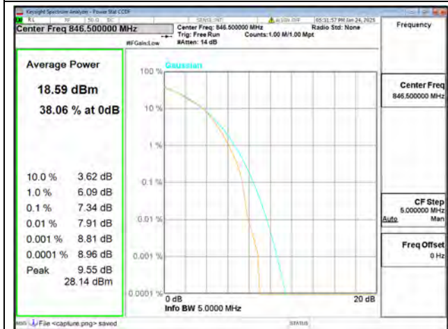
B5 / 5MHz / High CH / 64QAM
