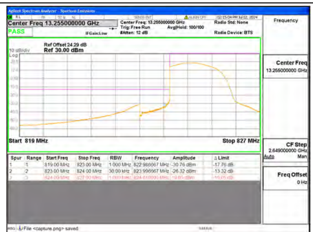
B5 / 1.4MHz / Low CH / QPSK / FULL RB
