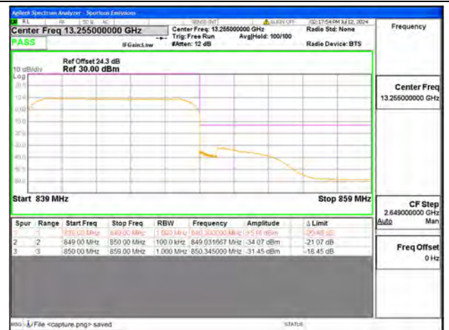
B5 / 10MHz / High CH / QPSK / FULL RB
