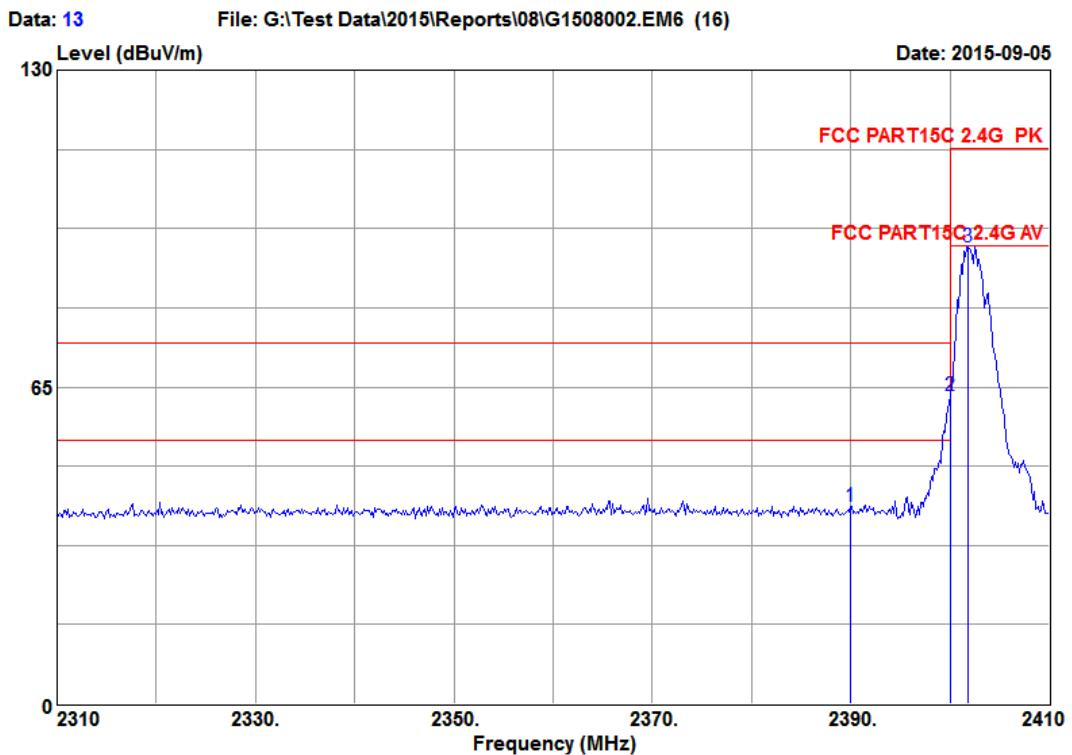
Site NO. : 3m Semi-Anechoic Chamber
