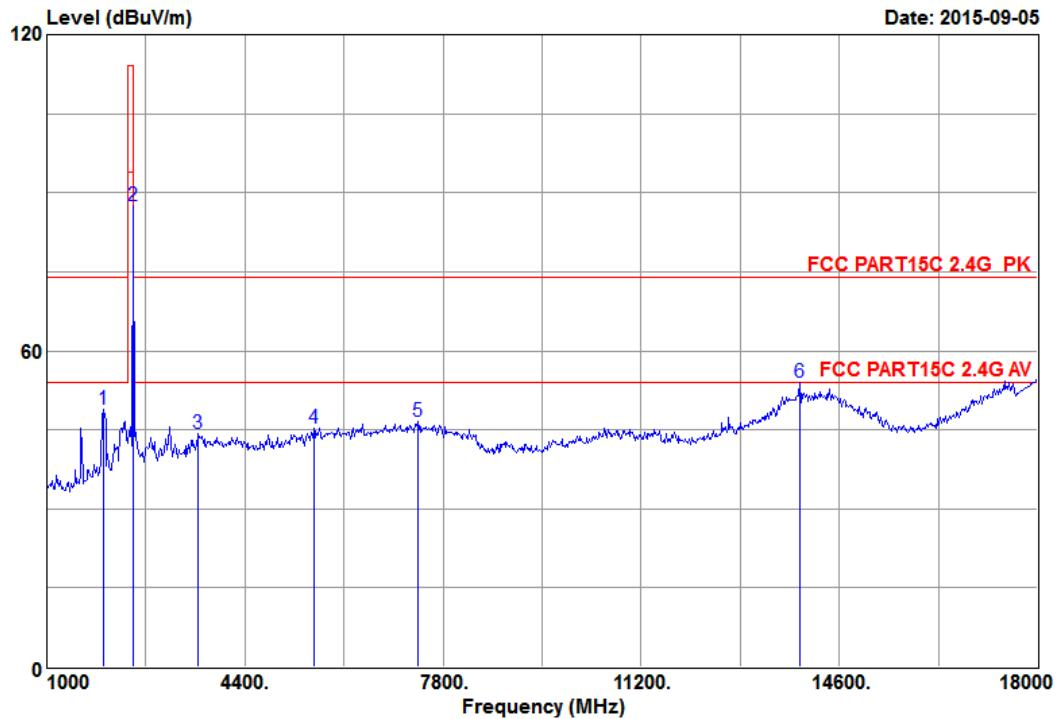
Site NO. : 3m Semi-Anechoic Chamber
