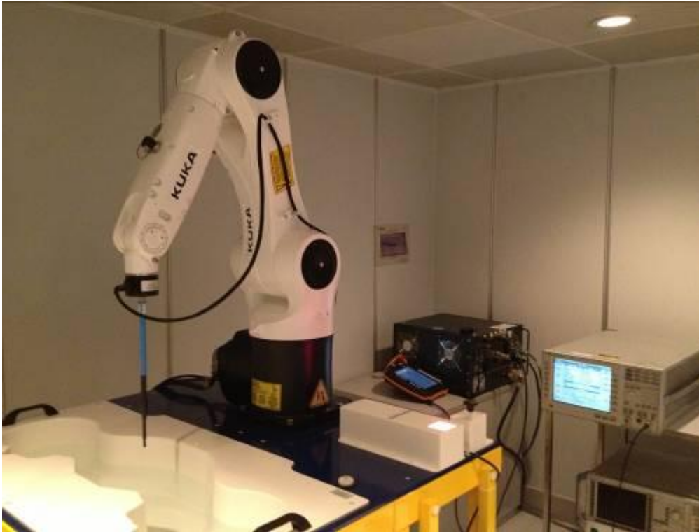
Fig.1 COMO SAR Test System
