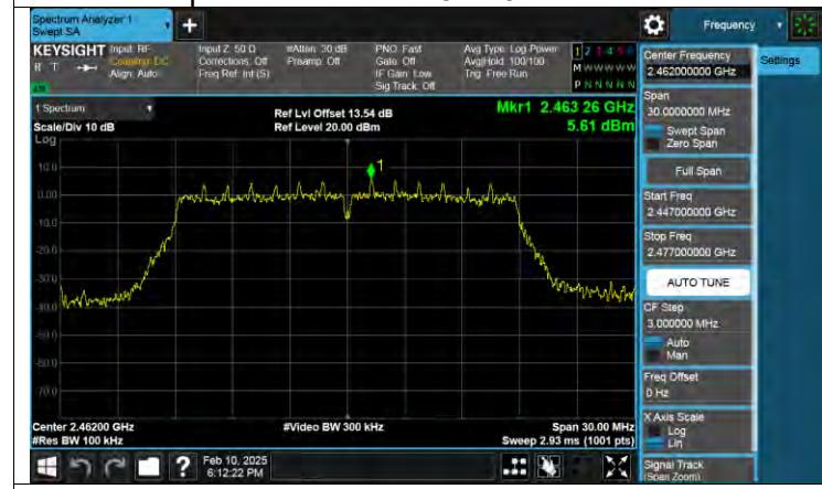
**Tx. Spurious NVNT n20 2462MHz Ant1 Emission**
