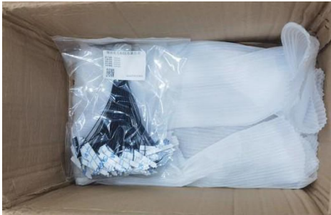
图2: 装箱PE 袋周围泡棉包住保护
